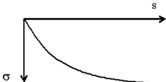
Рис.1 Экспериментально полученная зависимость \sigma-s (напряжения – деформации) при работе системы «свая-грунт» на горизонтальное воздействие
