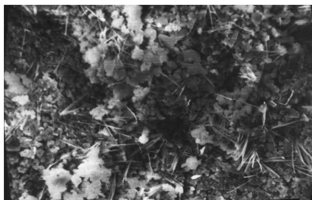
Рис. 1 Структура образца, содержащего 95% известняковых отходов и 5% БСНС (увеличение 1000х)
