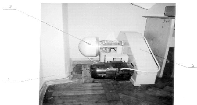
Рис. 9. Приводной блок установки автономного источника электроснабжения на базе ветрогенератора ВЭУ – 075/8, состоящий из приводного двигателя 1, клиноременной передачи 2, генератора 3, рамы и опорных конструкций.
