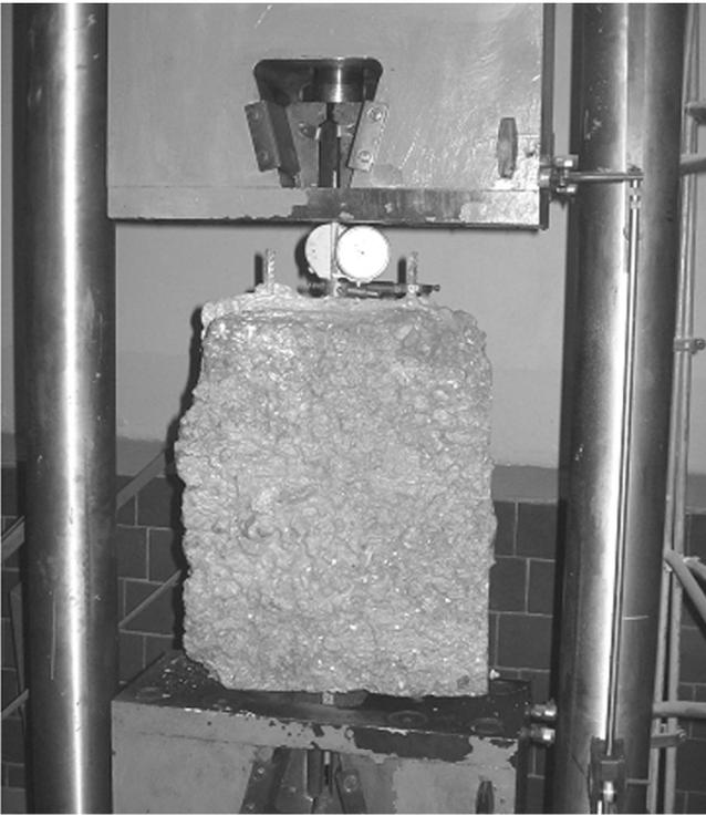
**Рис.5. Испытание фрагмента анкерного узла в разрывной машине**
