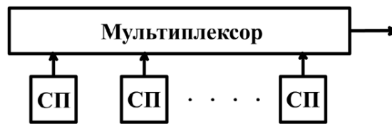
Рис.1 Блок-схема временного разделения каналов
