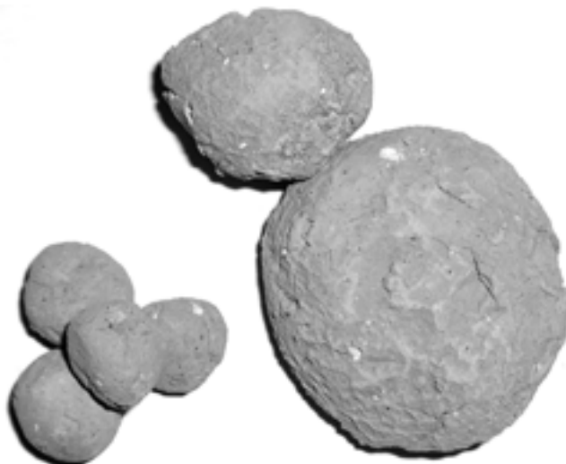
Рис. 1 Фотография образцов керамического гравия из формовочной смеси
