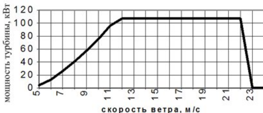
Рис.1. Кривая мощности ветротурбины USW 56-100.
