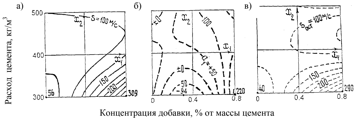
Рис. 3. Изолинии моделей среднеквадратического отклонения v_{uz} (а) в элементе, систематической a_1 (б) и случайной s_{ост} (в) составляющей v_{uz} .
