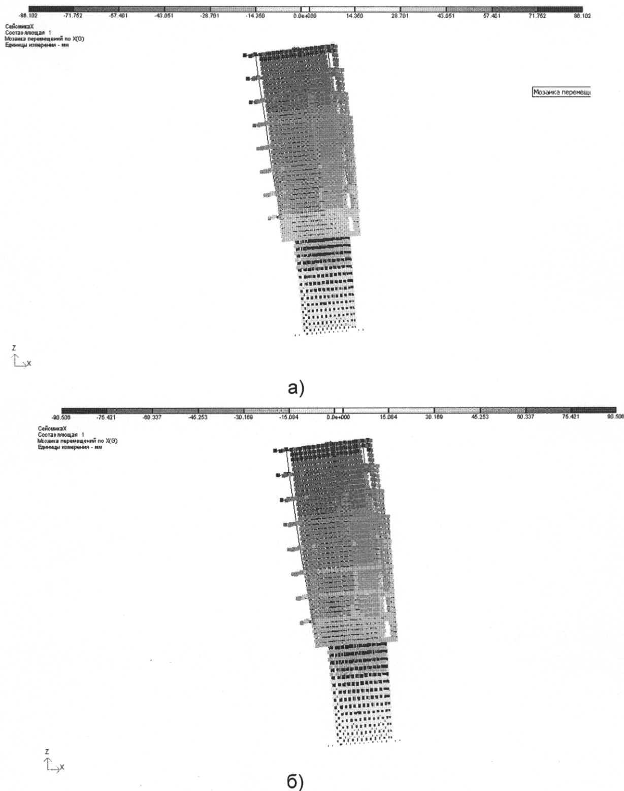
Рис.4. Деформированные схемы здания и мозаика перемещений при действии сейсмической нагрузки в поперечном направлении а) – при расчетной схеме по первому варианту; б) – при расчетной схеме по второму варианту.
