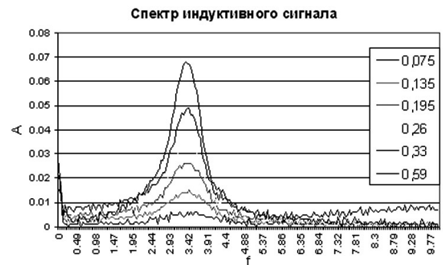
Рис. 2. Спектры сигналов индуктивного датчика при значениях начального смещения платформы 0.075-0.59 мм.
