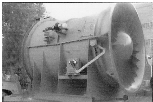
Рис. 1 Осовой двухступенчатый реверсивный вентилятор (ВОД)
