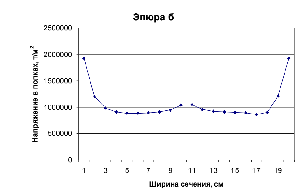
Рис. 4. Эпюра напряжений в полке ригеля.
