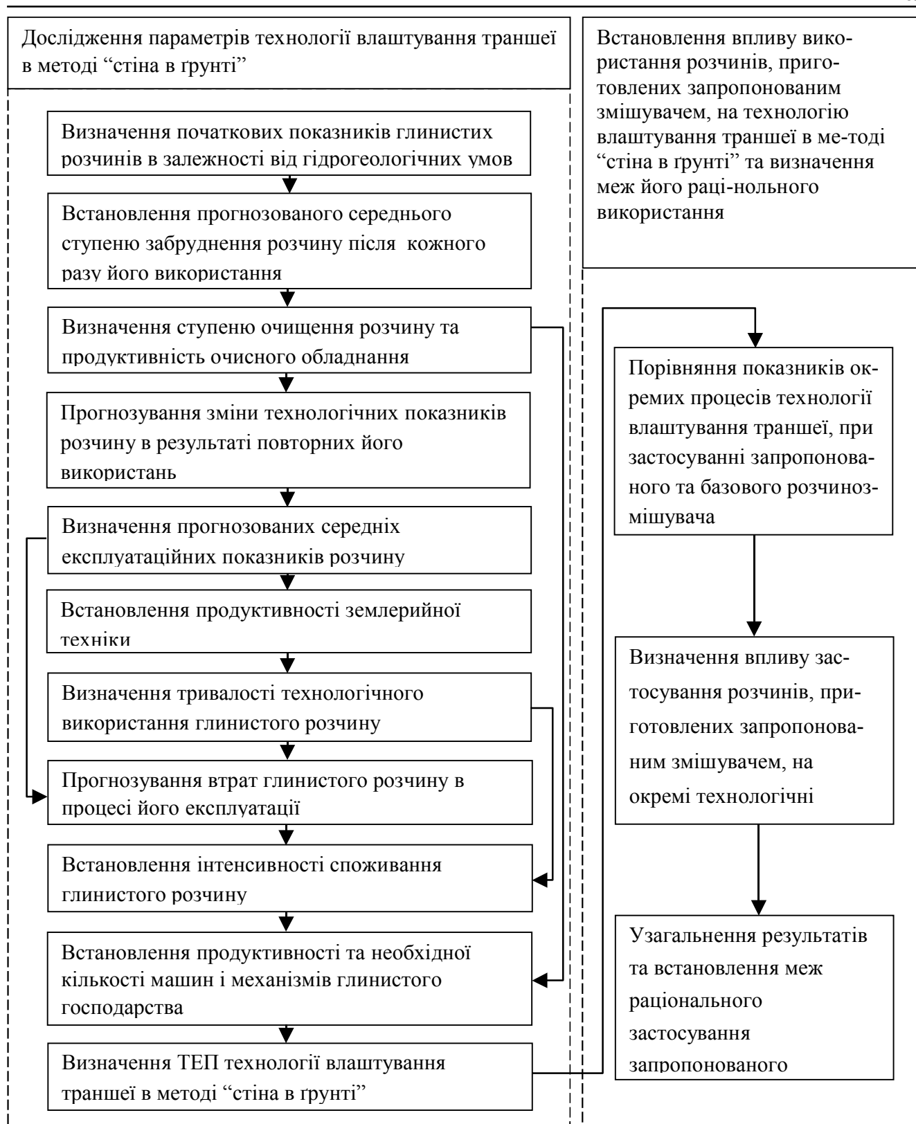
Рис. 1. Структурна схема методики дослідження технології влаштування траншеї в методі “стіна в ґрунті”, при використанні гідравлічного імпульсного змішувача.
