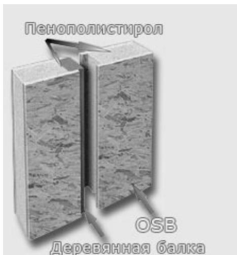
**Рис. 1. Структурные элементы панелей ЭкоПан**
