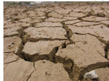
**Рис. 3. Фотографія висушеного осаду водоочисної станції**
