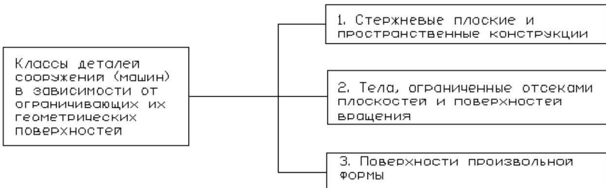
**Рис. 2. Классы геометрических объектов, подлежащих проектированию.**
