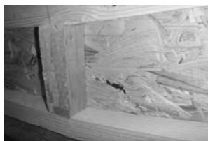
Рис. 4. Фрагмент балки с признаками разрушения после испытания: а - сдвиг стенки на левой опоре; б – трещина от растягивающих усилий в пролете у левого ребра жесткости
