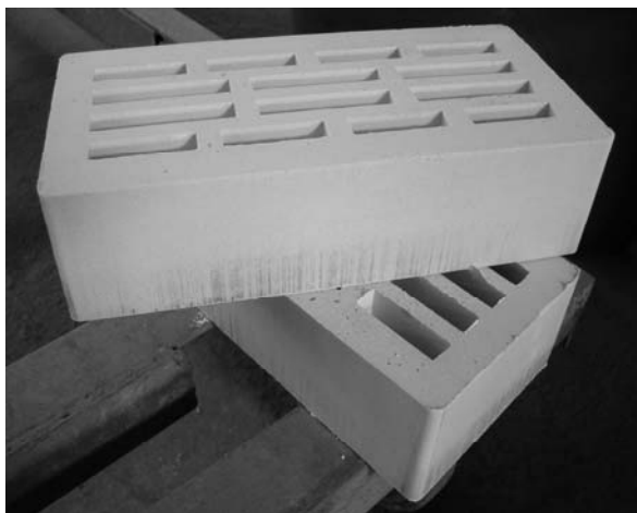
Рис. 3. Общий вид кирпичей после карбонизации.
