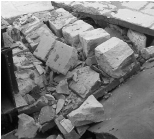
Рис.3. Разрушенный образец серии КО
