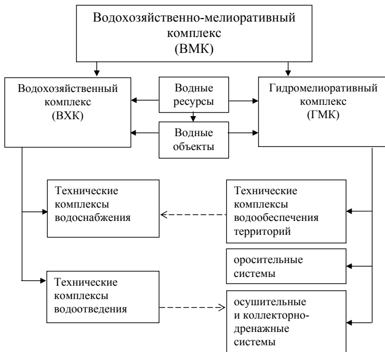
Рис. 1. Структурно-логическая схема основных элементов водохозяйственно-мелиоративного комплекса.
