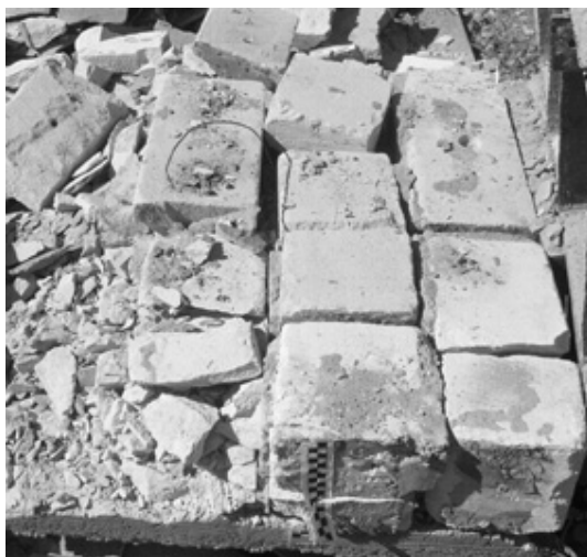
Рис.5. Разрушенный образец серии КОХ с хомутами ВРІ
