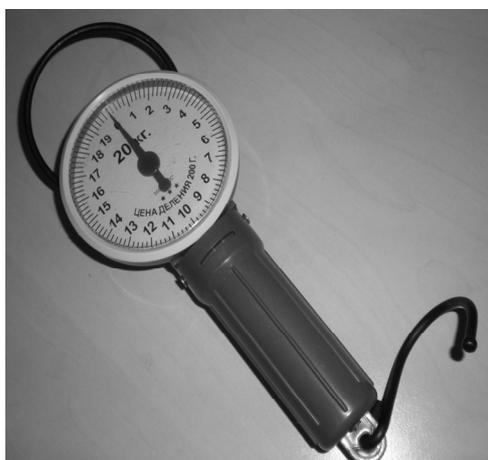
**Рис. 3. Динамометрический прибор, для определения усилий до 7 ярусов включительно второго яруса**
