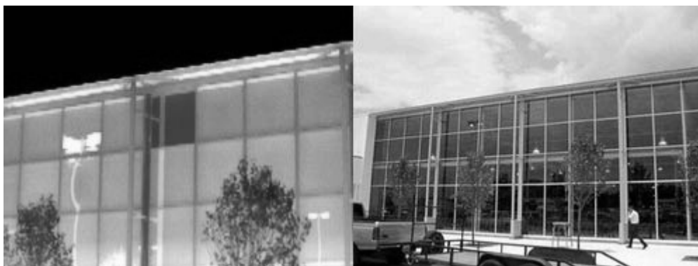
Рис.2 Сравнение окон с двойным и одинарным остеклением.
