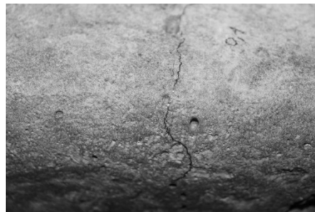
Рис. 6. Характер силових тріщин при досягненні звичайною плитою моменту тріщиноутворення
