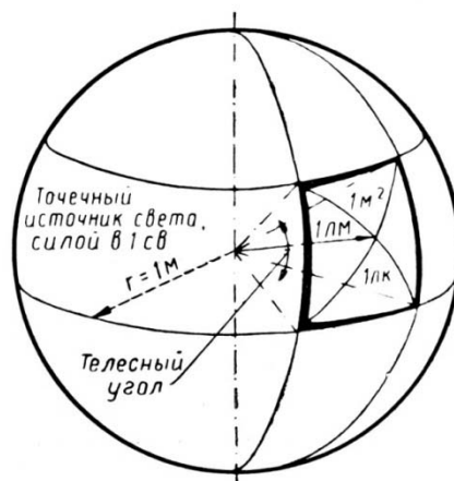
(Рис. 2) Зависимость между силой света, световым потоком и освещенностью
