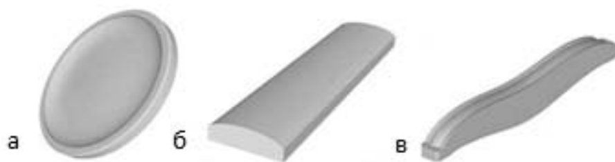
Рис. 1а-в. Форми асферичних лінз: а – фігура обертання; б – екструзивний тип; в – загальний тип
