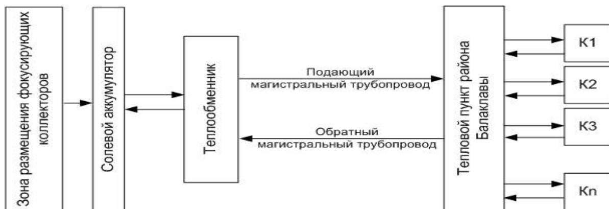
Рис. 2. Концепция централизованной системы солнечного теплоснабжения с использованием отработанного карьера в качестве емкостного солевого аккумулятора
