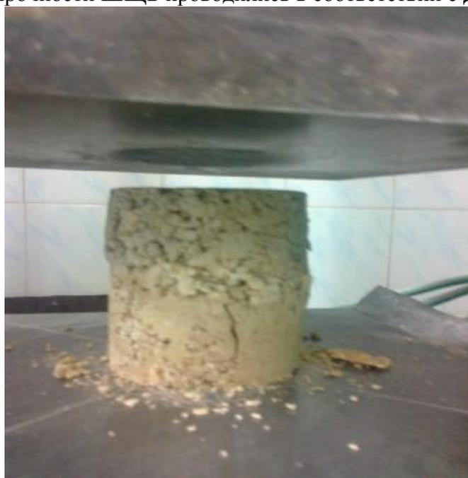
Рис. 3. Фотография испытаний цилиндров
