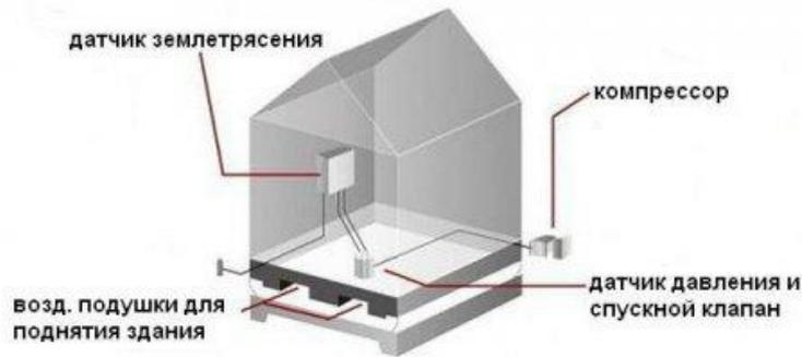
**Рис.3 Схема работы сейсмостойких систем**
