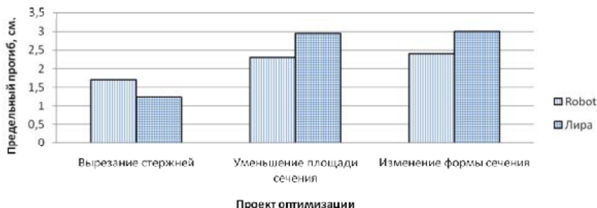
Рис. 5. Сравнение результатов расчёта в Лире и Robot
