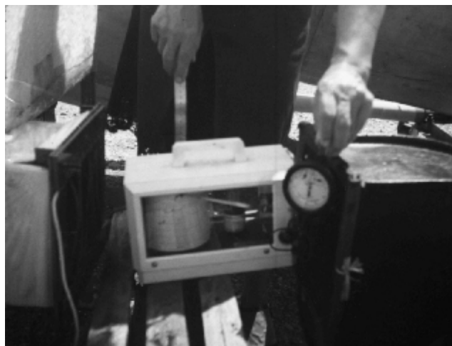
Рис. 2. Регистрация температуры воздуха, отсасываемого из гелиоколлектора
