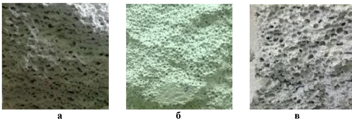
**Рис. 3. Ячеистая структура опытных образцов газобетона марки D500, получаемых из смеси известково-цементного вяжущего состава, % мас.: 70 : 30 (а, б) и 50 : 50 (в) и алюминиевой пудры в количестве 0,12 % мас. при температуре 303 К, в зависимости от показателя текучести смеси на вискозиметре Суттарда Суттарда, см:
