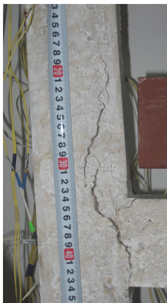
Рис. 3 Схема разрушения опорных сечений ригелей а) А-1/Б-1, б) А-2/Б-2 и в) А-3/Б-3 после запроектного воздействия на вторую опытную раму.
