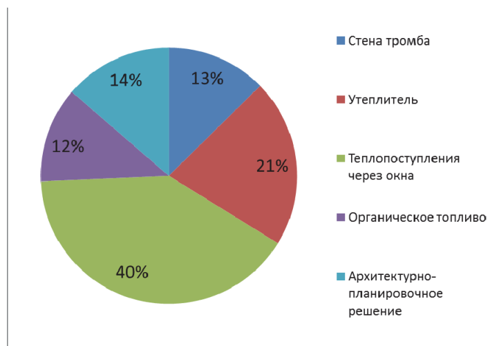
Рис. 2 Тепловой баланс здания за отопительный период
