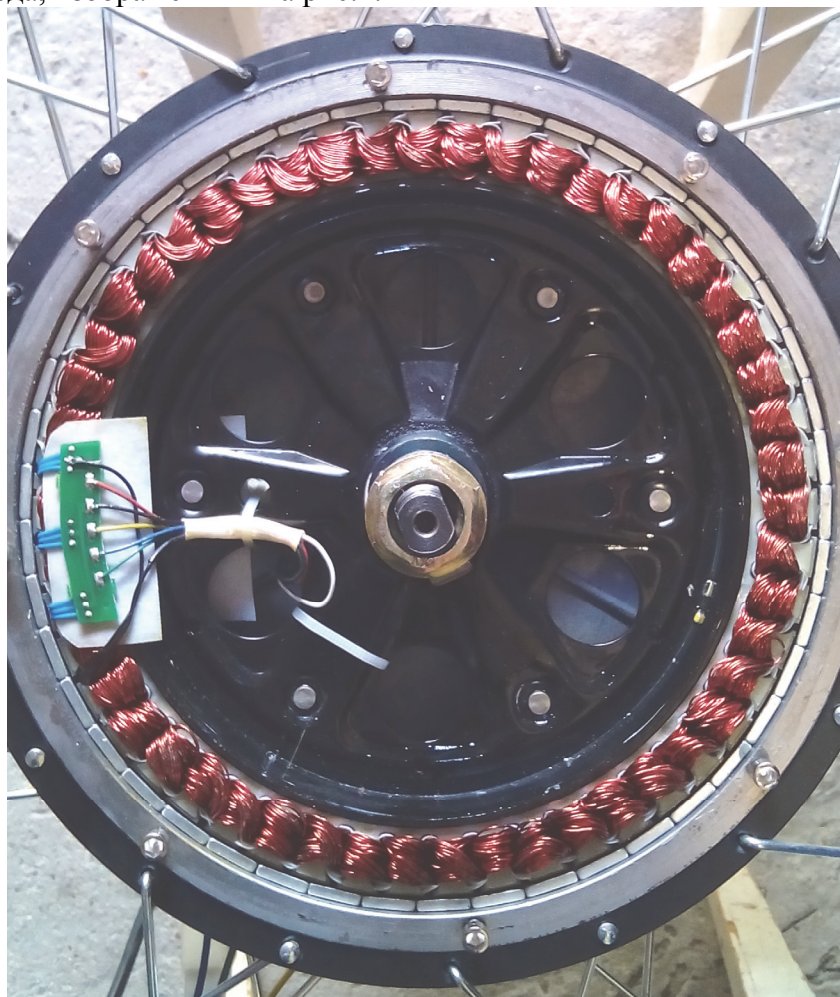
Рис. 1. Электропривод велосипедный, бесколлекторный.
