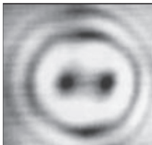
Рис. 3. Коноскопическая картина одноосного кристалла LiNeO_3 вдоль оптической оси
