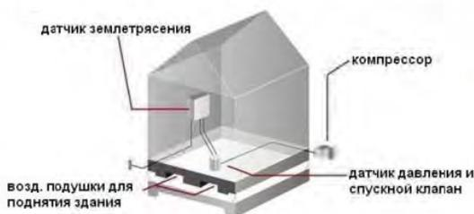
Рис. 2. Схема работы сейсмостойких систем
