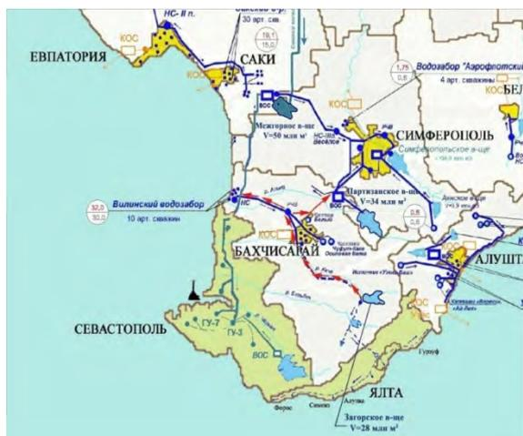
Рис. 2 Схема строительства водовода от Загорского водохранилища
