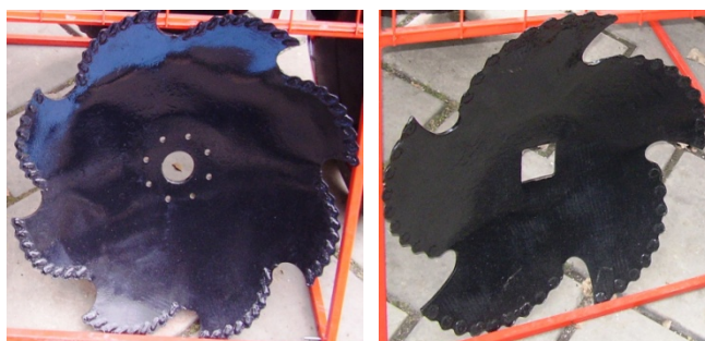
Диски борон с прерывистой наплавкой
