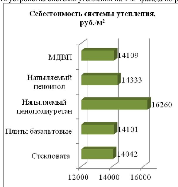
Рис.4 . Удельная себестоимость системы утепления по рассмотренным вариантам
