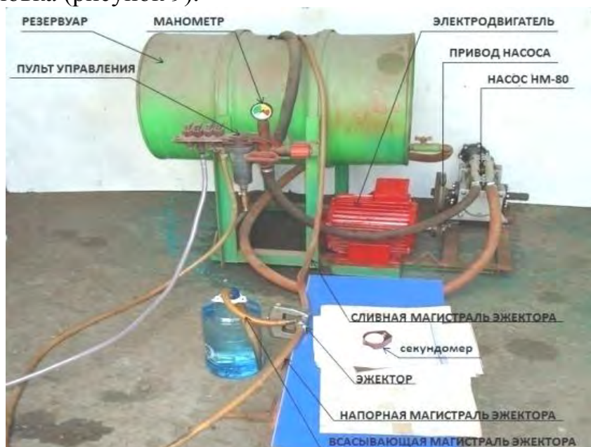
Рисунок 9 – Лабораторная установка для изучения характеристик эжектора
