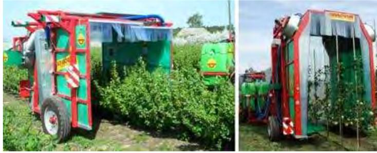
Рисунок 1.2 – Садовый туннельный опрыскиватель ISK-1
