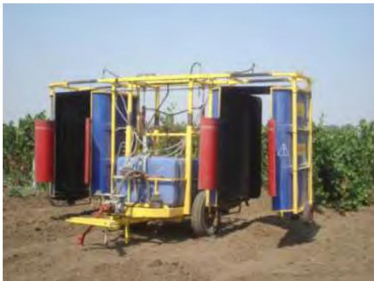
Рисунок 5.1 – Опрыскиватель камерный прицепной виноградниковый (туннельного типа) ОКПВ–1000
