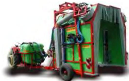
Рисунок 1.1 – Садовый туннельный опрыскиватель EKOSAD-TUNEL
