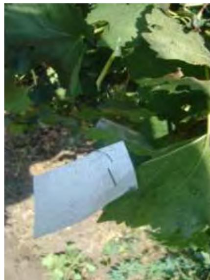
Рисунок 3.19 – Контрольные карты после прохода опрыскивателя
