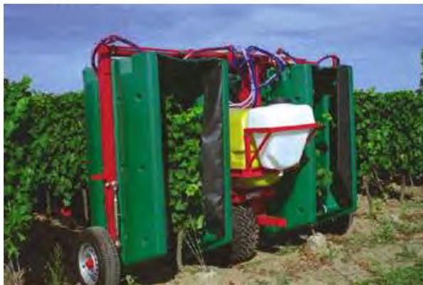
Рисунок 1.4 – Двухрядный туннельный опрыскиватель LIPCO
