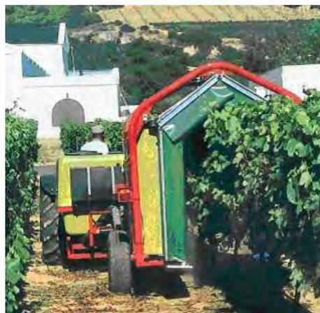
Рисунок 1.3 – Опрыскиватель Wine Tunnel
