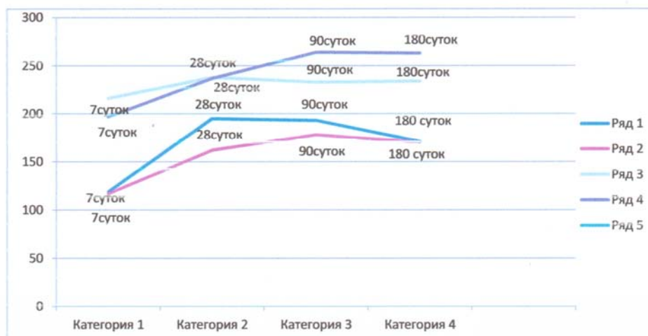
График.1 Набор прочности бетона на сульфатостойком цементе (ССПЦ) в нормальных стандартных условиях; 1 – состав № 1; 2 – состав № 2; 3 – состав № 3; 4 – состав № 4;
