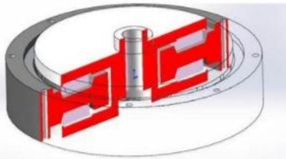
Рис. 1. 3-D модель генератора осевого потока
