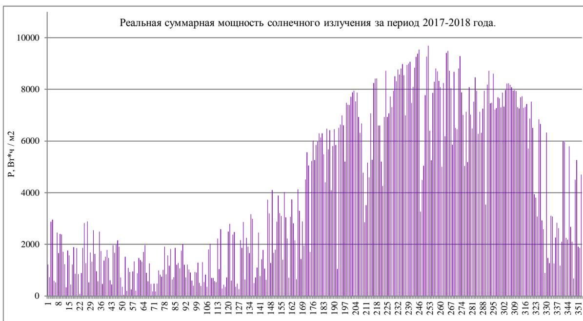
Рис. 6. График суммарной мощности, полученной от солнечной батареи в течение года
