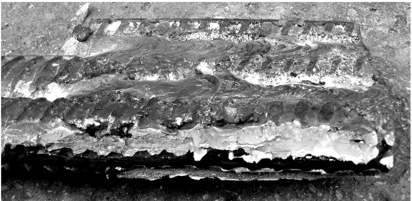
**Рис.7. Разрушение сварного шва при изгибе арматурного пакета**
