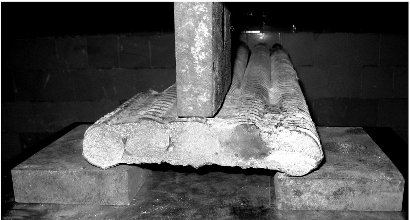
**Рис.6.Общий вид испытания арматурного пакета на изгиб**
