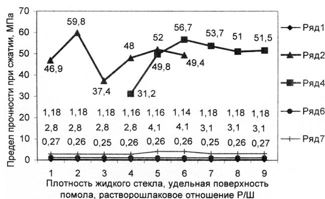
**Рис. 4. Влияние плотности жидкого стекла, удельной поверхности помола и растворошлакового отношения на предел прочности при сжатии образцов кубиков размером 2х2х2 см из шлакощелочного вяжущего, испытанных в 28 суток естественного твердения.**
