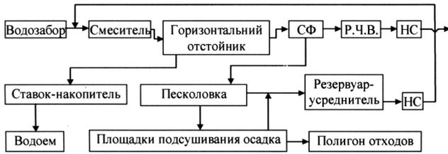
**Рис.2. Схема обработки осадков из горизонтальных отстойников и грязных промывных вод фильтров**
