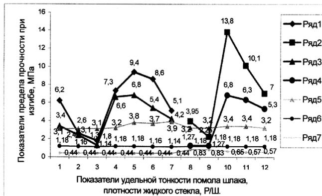
**Рис. 2** Зависимость предела прочности при изгибе шлакощелочных цементно-песчаных растворов на жидком стекле с силикатным модулем  $M_c = 1,5 \dots 1,7$  от удельной поверхности шлака, плотности жидкого стекла, Р/Ш.
