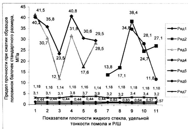
**Рис. 1** Зависимость предела прочности при сжатии шлакощелочных цементно песчаных растворов на жидком модифицированном стекле с силикатным модулем  $M_c = 1,57 \dots 1,67$  от плотности жидкого стекла, удельной поверхности шлака и Р/Ш (растворошлакового отношения).
