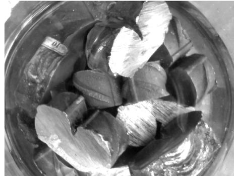
Рис. 2 Травление микрошлифов в 10-ти % спиртовом р-ре серной кислоты
