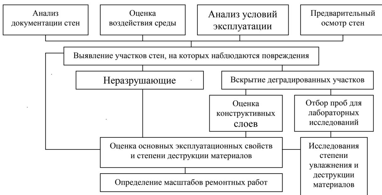
**Рис. 1. Схема обследования стен и испытаний строительных материалов**
