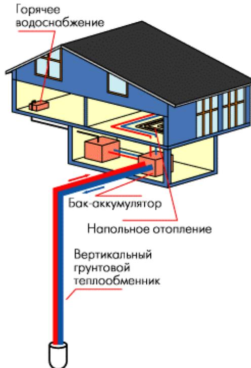
**Рис. 3. Схема отопления и горячего водоснабжения с использованием ТН с вертикальным грунтовым теплообменником**
