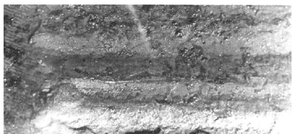
**Рис. 1. Поверхность броневых вкладышей ШМ при исследовании под микроскопом (x300). Сталь ХВГ.**
