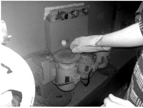
Рис. 1 Изготовление микрошлифов
