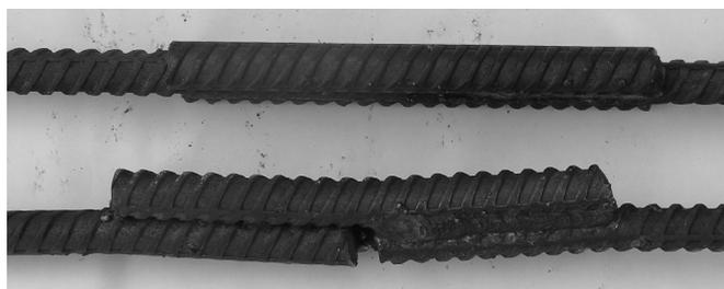
Рис. 3. Сварные стыки арматуры со смещенными боковыми накладками во внутрь колонны, после испытания.
