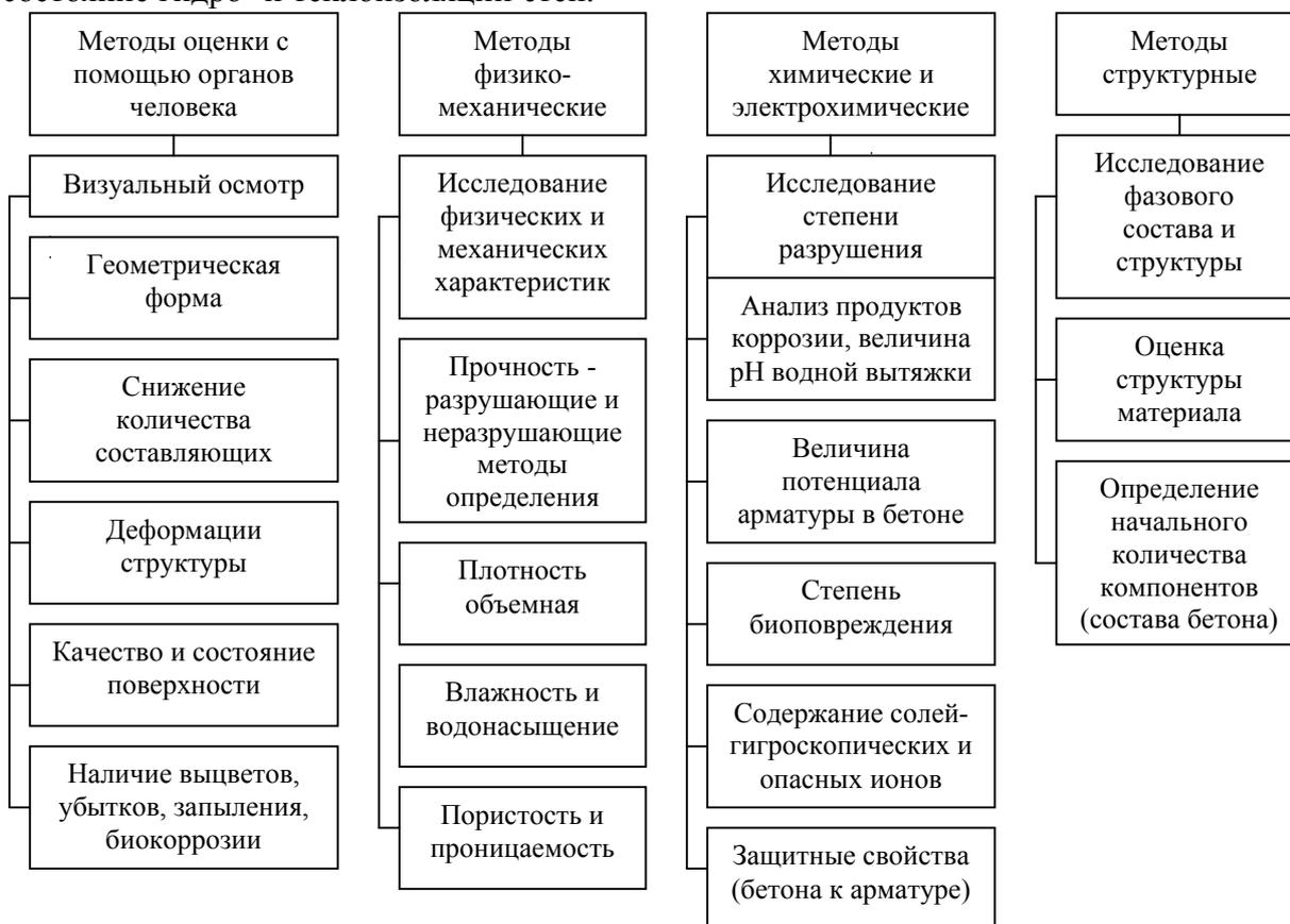
**Рис. 2. Методы оценки состояния материалов в конструкциях**
