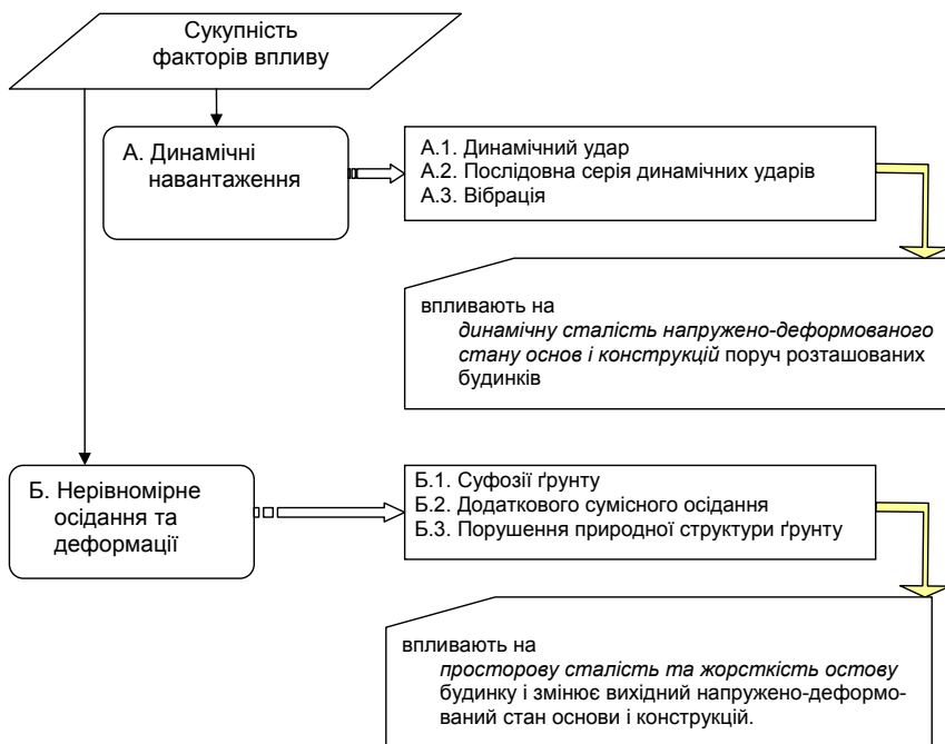
Рис. 1. Модель декомпозиції основних факторів впливу нового будівництва на поруч розташовані будинки
