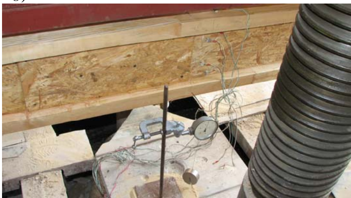
Рис.2. Испытание балок а – общий вид испытания; б – прогибомер 6ПАО и тензорезисторы подключенные к тензометрическому мосту ЦТМ-3 в середине пролета балки
