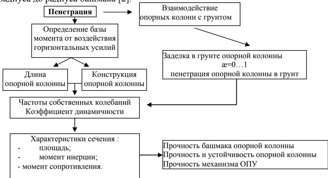
**Рис. 1. – Схема влияния пенетрации опорных колонн при взаимодействии с грунтом на определение характеристик СПБУ**
