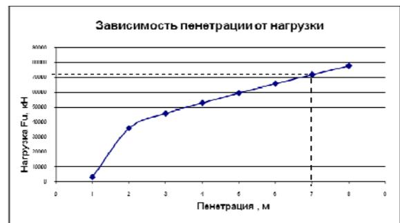
Рисунок 4 – Определение глубины продавливания
