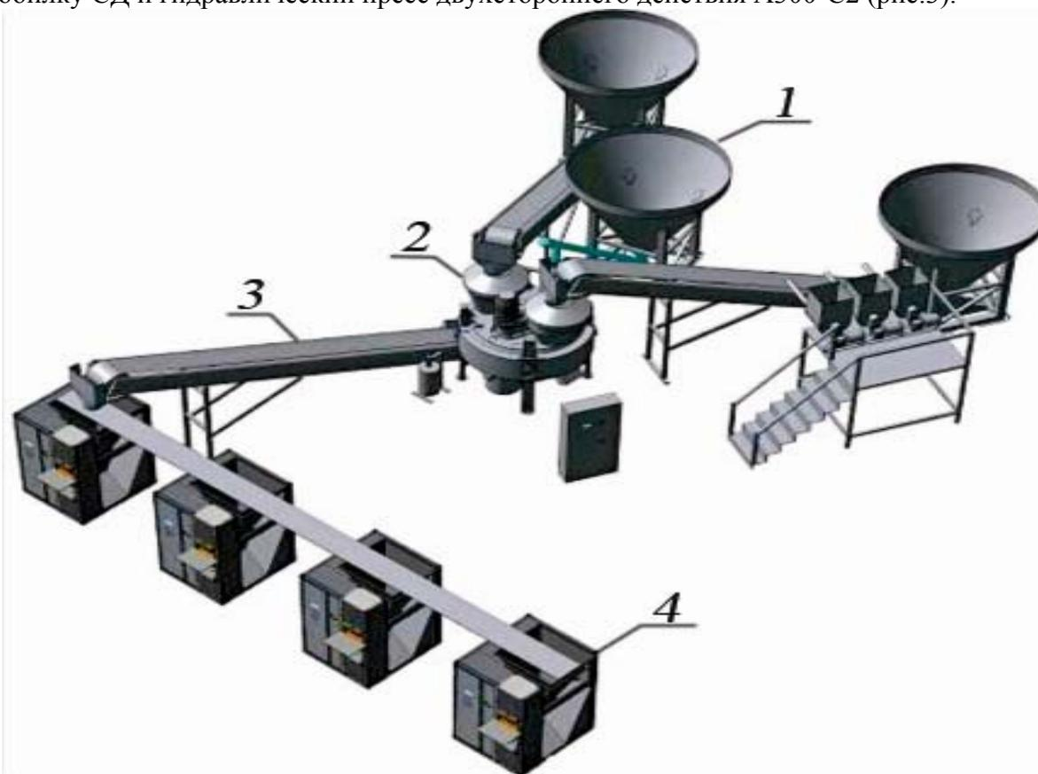
**Рис. 2. Технологическая линия для производства лицевого кирпича методом полусухого прессования: 1 – бункера для хранения сырьевых компонентов, 2 – смесительно-загрузочный комплекс (СЗК), 3 – ленточный транспортер, 4 – гидравлический пресс двухстороннего прессования.**
