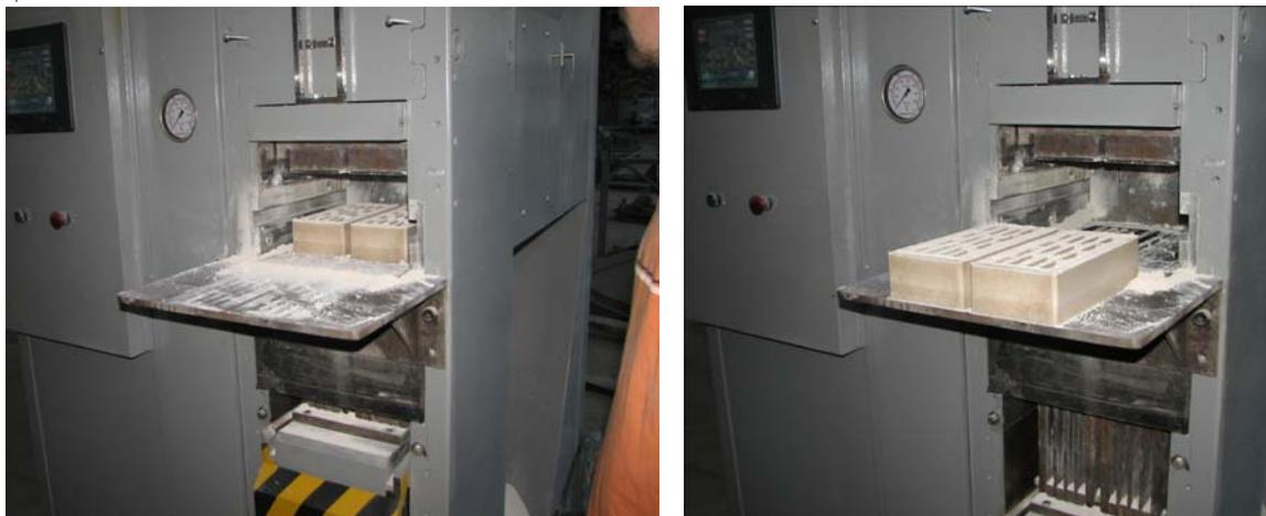
**Рис. 3. Процесс формования кирпича на прессе А 300-С2.**
