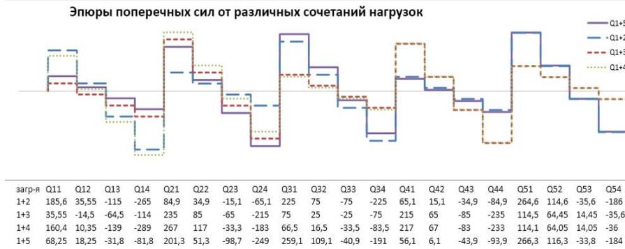
Рис. 3. Эпюры поперечных сил от различных сочетаний нагрузок
