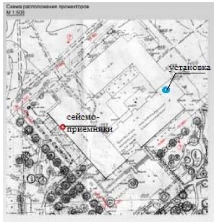
**Рис. 2** Схема расстановки сейсмоприемников и генераторной установки
