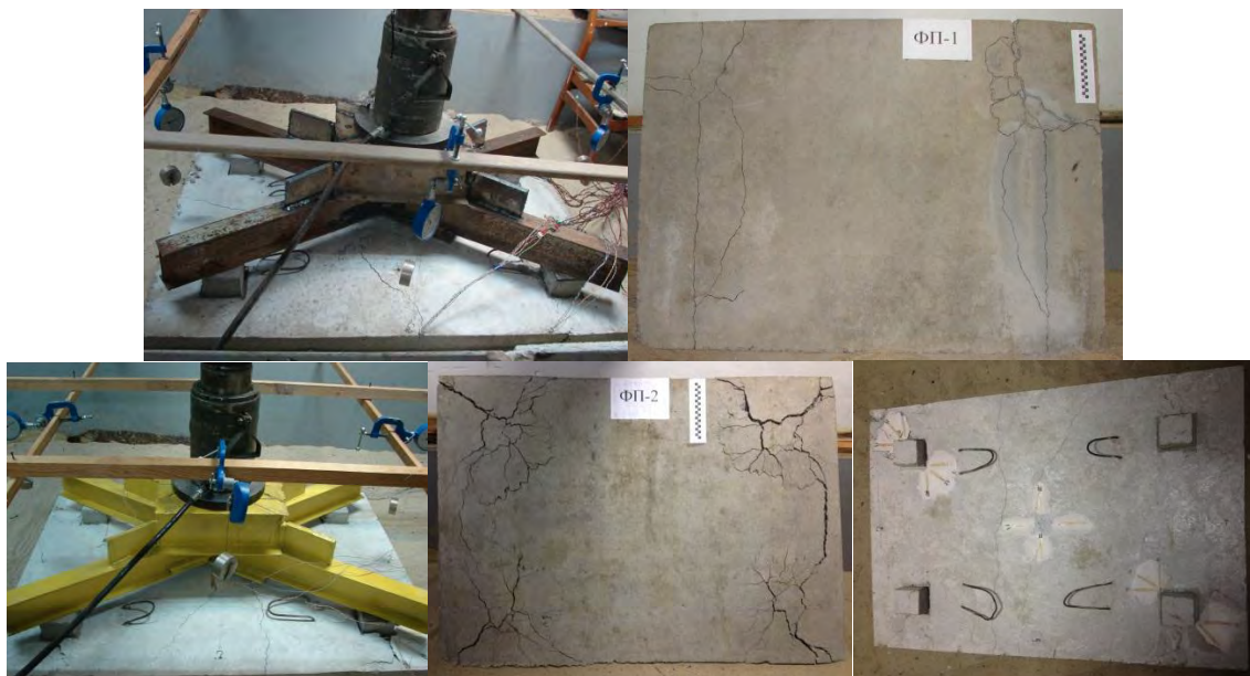
Рисунок 1 - Фото разрушенных моделей плитного фундамента
