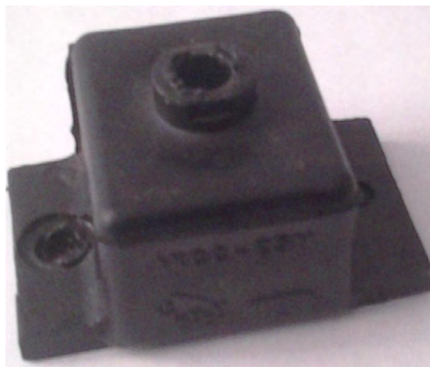
Рис. 4. Амортизатор АКСС-25М Одесского завода резиновых изделий.
