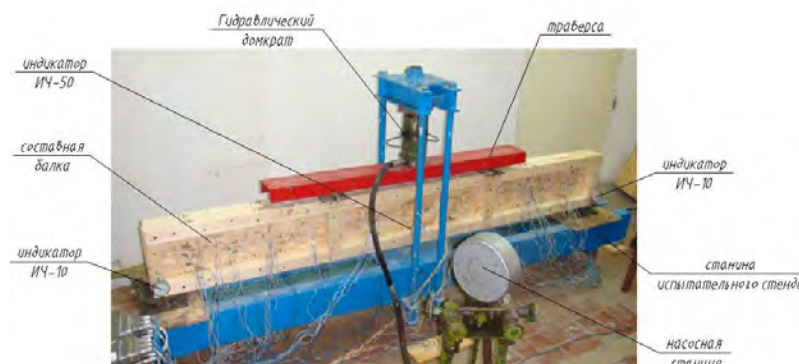
Рисунок 2 - Испытательный стенд с экспериментальным образцом. Нагружение производилось гидравлическим домкратом
