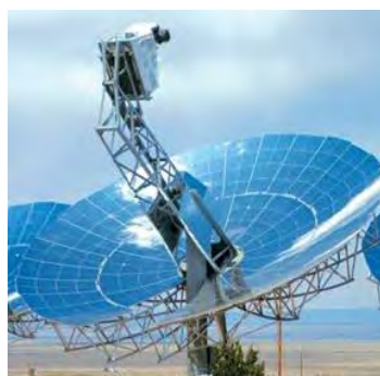
Рисунок 2 – Факетный концентратор, состоящий из двух плоских отражателей 1- плоский отражатель (зеркало); 2 – приемник солнечного излучения
