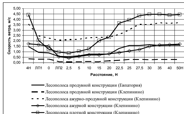
Рис. 2 Скорость ветра в зависимости от конструкции лесополосы на высоте 0,3 м.
