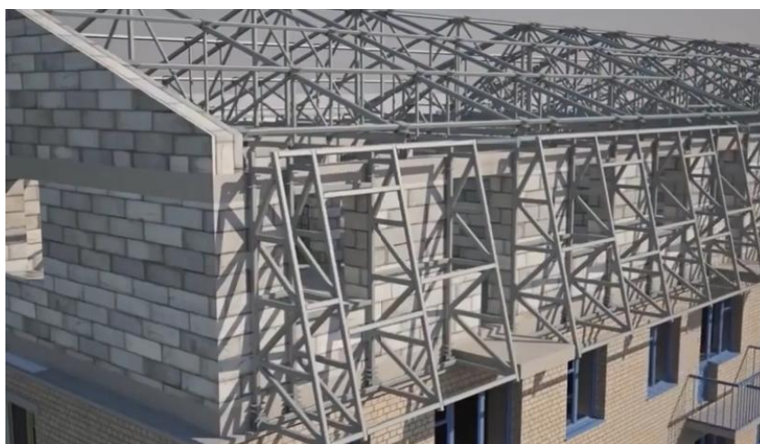
Рис. 10. Принципиальная схема технологии настраиваемого мансардного этажа из мелких облегченных блоков с устройством металлического каркаса обстройки мансарды (третий вариант)
