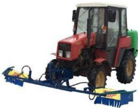
Рисунок 1.6 – Машины для внесения гербицидов: а – «ГЕРБИ/ДС – 2»; б – НШ «ГЕРБИ – 1»
