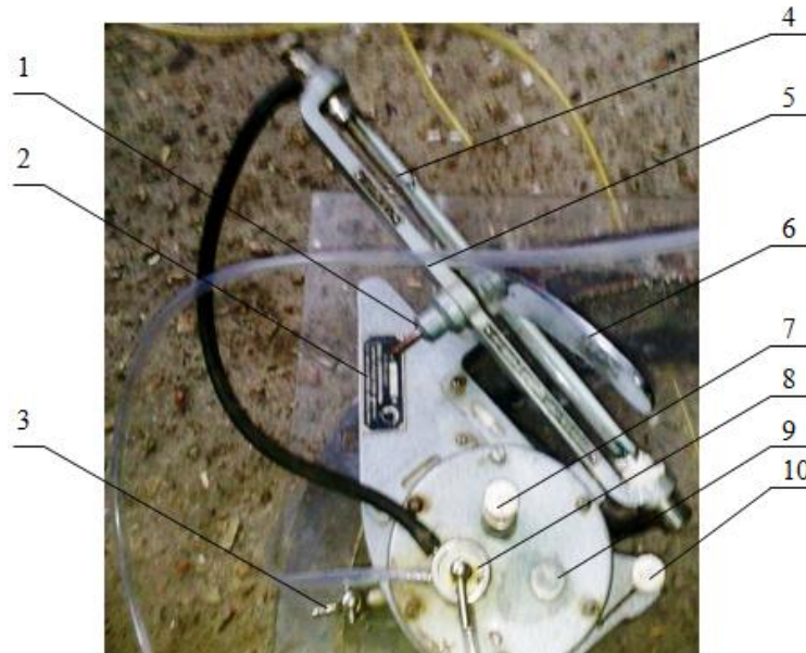
Рисунок 3.7 – Трубка Пранделя: 1 – фиксатор; 2 – плита; 3 – сливной кран для слива жидкости; 4 – стеклянная трубка; 5 – кронштейн; 6 – стойка; 7 – отверстие для заливки и регулятора нулевого положения мениска; 8 – трехходовой кран; 9 – заливочная пробка; 10 – регулировочные винты
