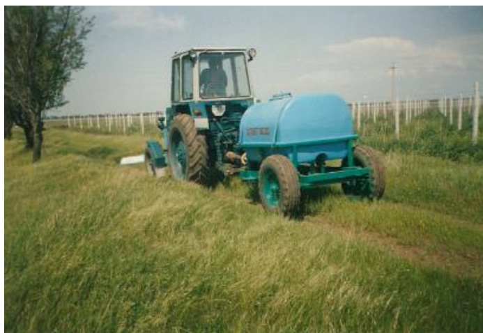
Рисунок 1.13 – Агрегатирование машины «МГВ – 300/500» с прицепным опрыскивателем «ОПСВ – 1500»
