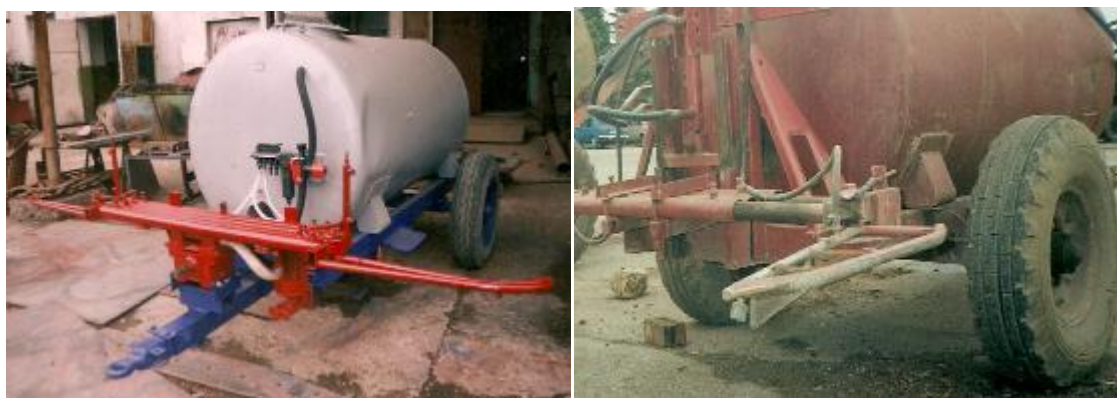
Рисунок 1.9 – Опрыскивателю ОПВ – 2000 для уничтожения сорных растений в приштамбовой зоне виноградников
