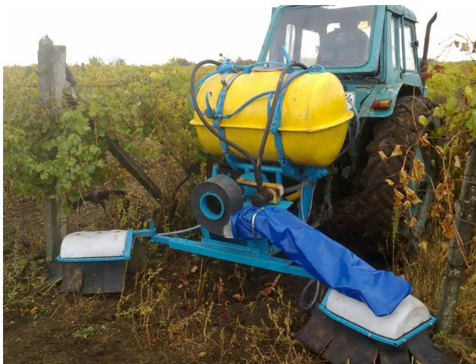
Рисунок 5.2 – Проведение испытаний машины для внесения гербицидов в приштамбовых зонах виноградников
