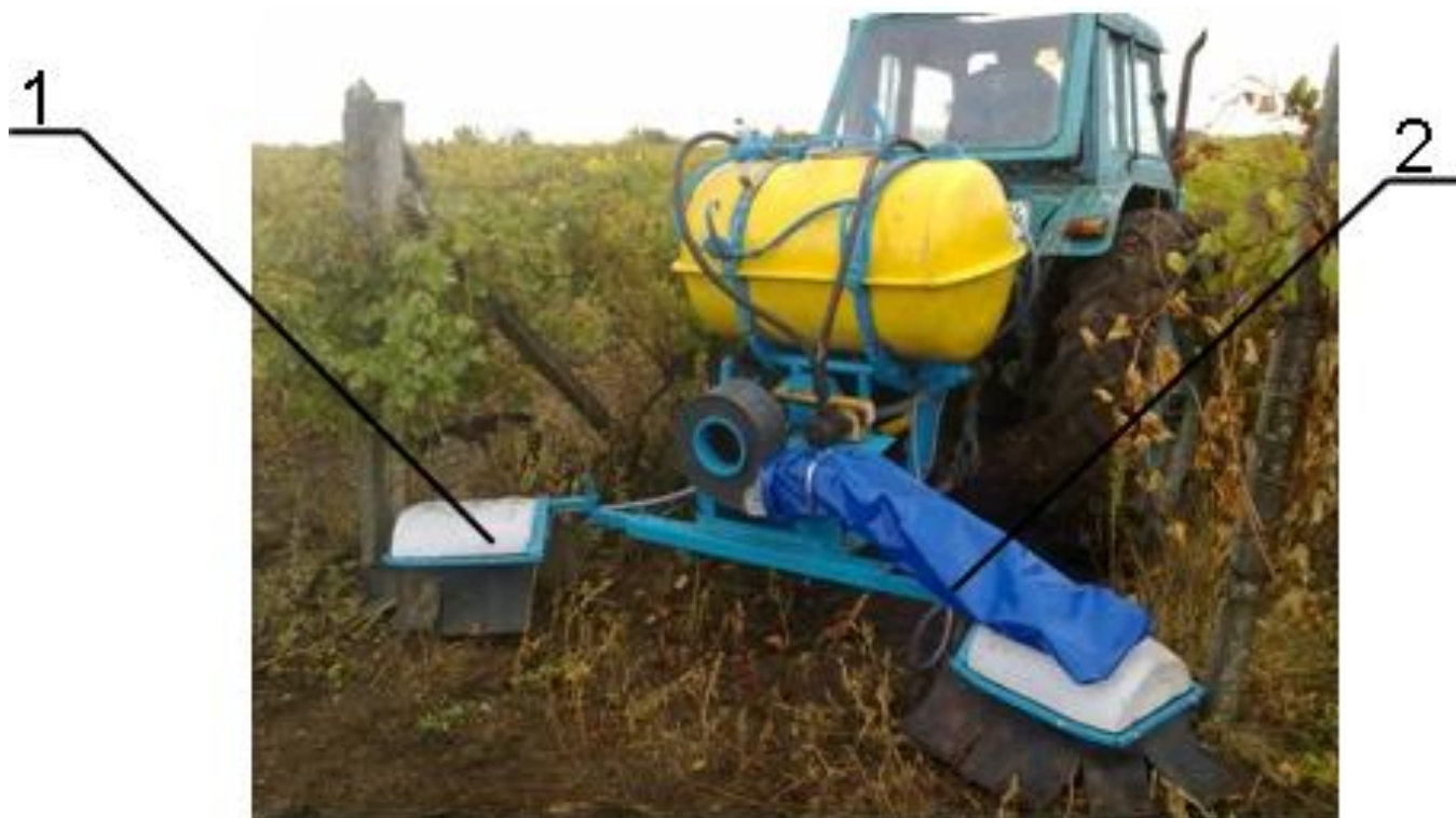
Рисунок 3.1 – Лабораторно-полевая экспериментальной установка опрыскивателя навесного гербицидного виноградникового: 1 – без воздушной поддержки; 2 – с воздушной поддержкой
