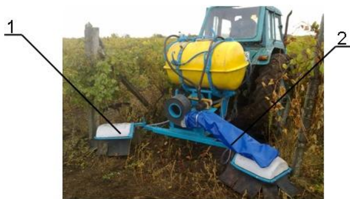
Рисунок 7 – Лабораторно-полевая экспериментальной установка опрыскивателя навесного гербицидного виноградникового
