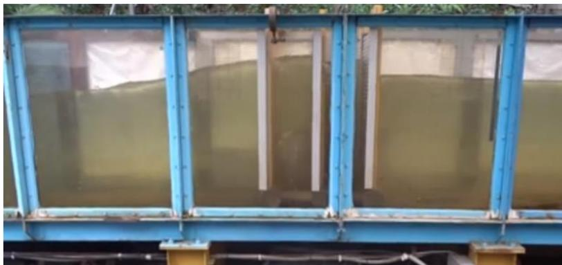
Рис.4. Волногасящая эффективность «Гребенки» при лотковых испытаниях
