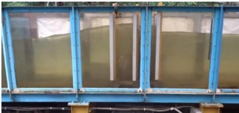
Рис.4. Волногасящая эффективность «Гребенки» при лотковых испытаниях
