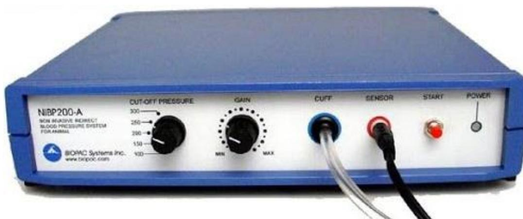
Рисунок 2.14 – Внешний вид системы неинвазивного измерения артериального давления и частоты сердечных сокращений у мелких лабораторных животных
