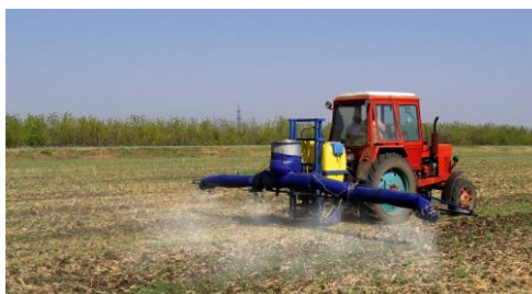
Рисунок 18 – Общий вид опытного образца опрыскивателя в составе с МТЗ–82 при проведении лабораторно – полевых исследований
