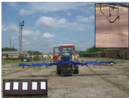
Рисунок 10 – Общий вид штангового опрыскивателя при исследованиях традиционного способа опрыскивания карточек подкрашенной жидкостью
