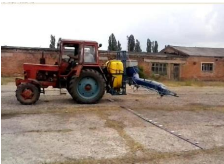
Рисунок 16 – Общий вид опрыскивателя, оснащенного 4мя пневмогидравлическими устройствами с соплами LU – 02 AD – 02 (код цвета – желтый )
