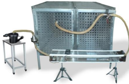
Рисунок 11 – Общий вид оборудования при определении концентрации мелкодисперсного аэрозоля в решетчатом корпусе с применением ДАК
