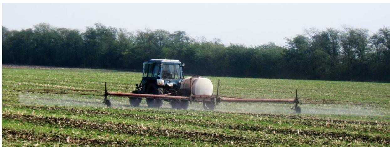
Рисунок 4.67 – Общий вид базового варианта опрыскивателя в составе с МТЗ–82 при проведении лабораторно – полевых исследований
