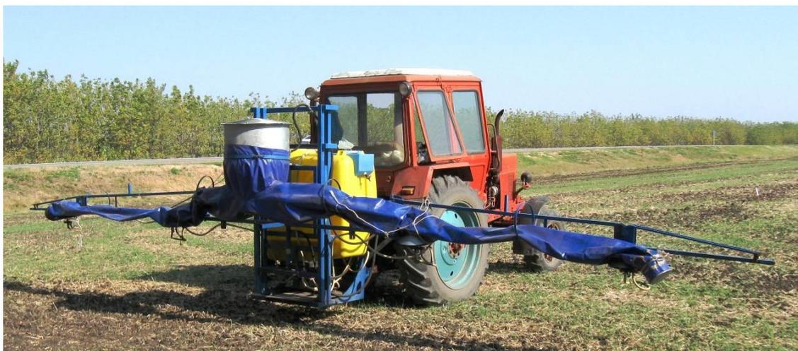
Рисунок 4.65 – Общий вид опытного образца опрыскивателя с МТЗ–82 перед началом проведения лабораторно – полевых исследований
