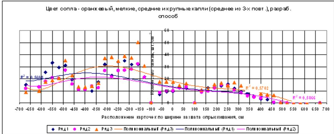
Рисунок 4.41 – Плотность покрытия картонок каплями, создаваемыми пластиковыми соплами (код цвета – **оранжевый**), полученная при предложенном способе опрыскивания
