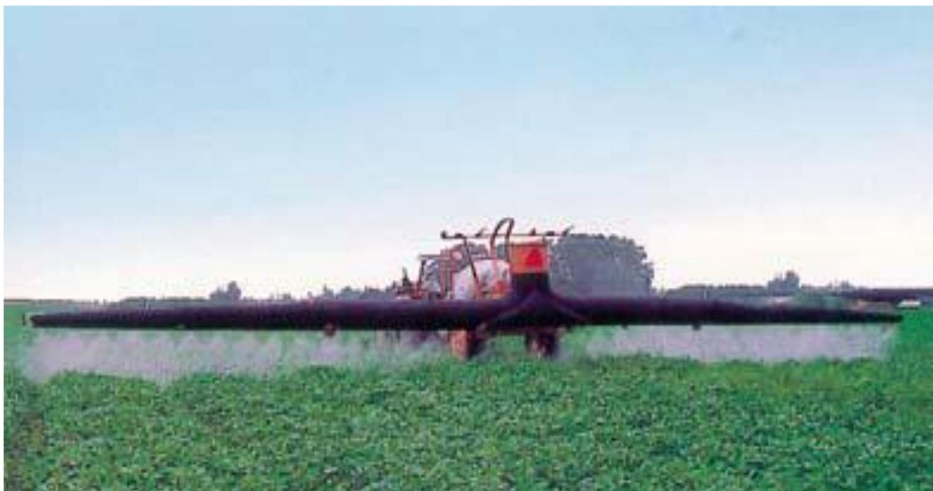
Рисунок 1.15 – Опрыскиватель с воздушным рукавом
