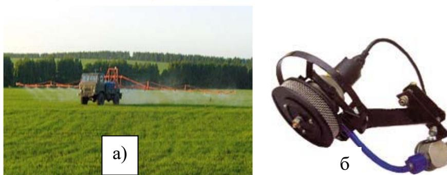
а) – общий вид “штангового опрыскивателя «Заря ОП-2000Г» на базе автомобиля ГАЗ-66 (ширина захвата 28 м, шаг установки распылителей 1,5 м);
