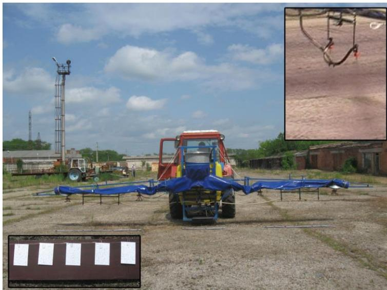
Рисунок 4.62 – Штанговый опрыскиватель при исследованиях традиционного способа опрыскивания карточек подкрашенной жидкостью
