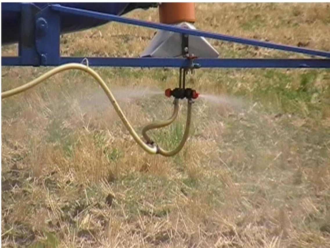
Рисунок 4.47 – Фрагмент нанесения раствора гербицида на растения пневмогидравлическим устройством со щелевыми распылителями в составе экспериментального опрыскивателя при проведении лабораторно – полевых исследований [84, 68, 96, 69, 93]
