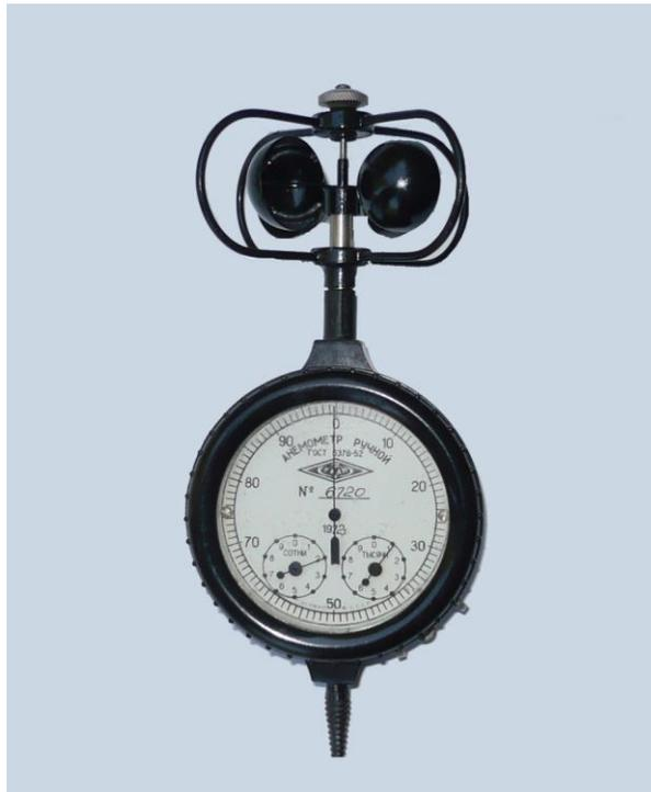
Рисунок 3.17 – Чашечный анемометр
