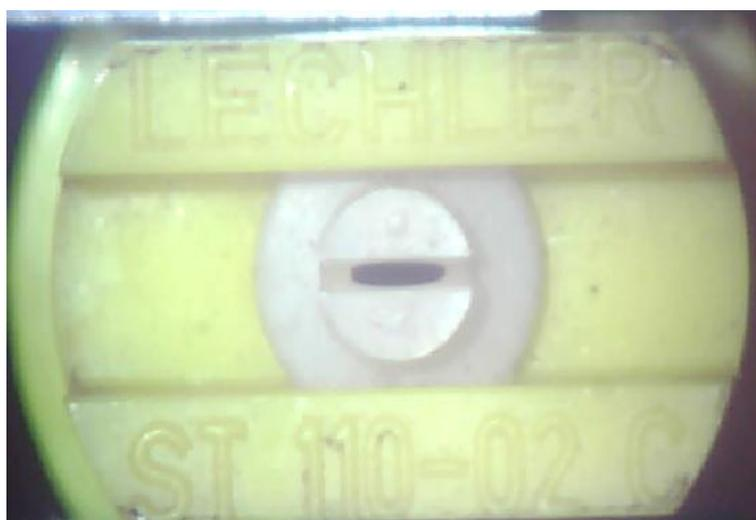
Рисунок 2.15 – Общий вид сопла (щелевого)
