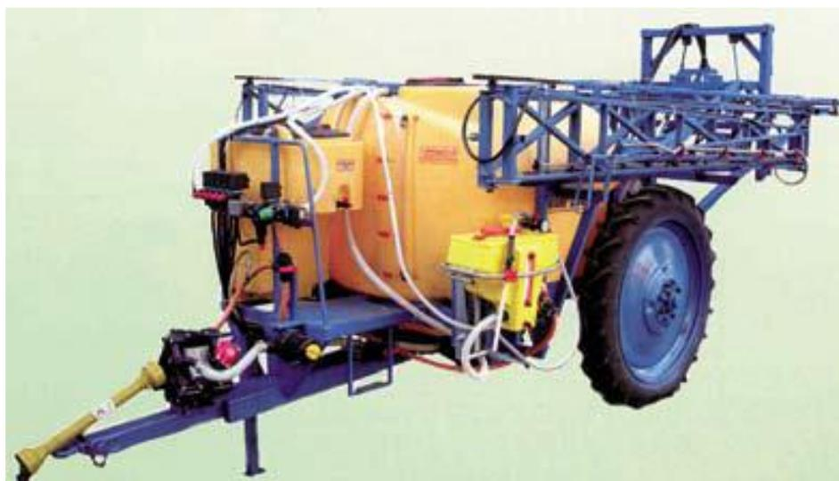
Рисунок 1.5 – Прицепной опрыскиватель ОПМ-2505 В
