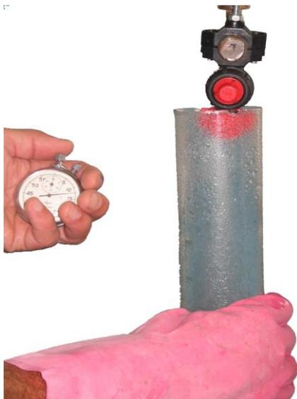
Рисунок 3.6 – Средства измерения расхода жидкости [106]: секундомер и мерный цилиндр
