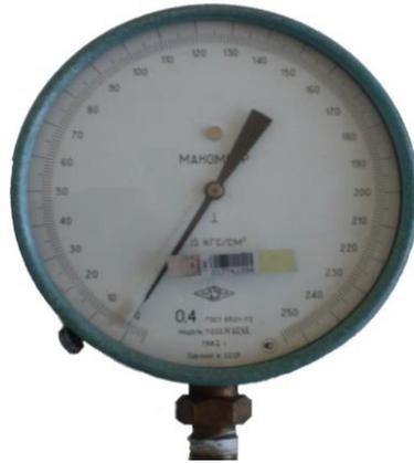
Рисунок 3.9 – Поверенный жидкостной манометр [106]
