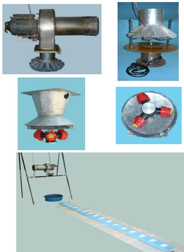
**Рисунок 4.22** Общий вид макетных образцов пневмомеханических и пневмогидравлических устройств с дисковым и щелевыми распылителями жидкости
