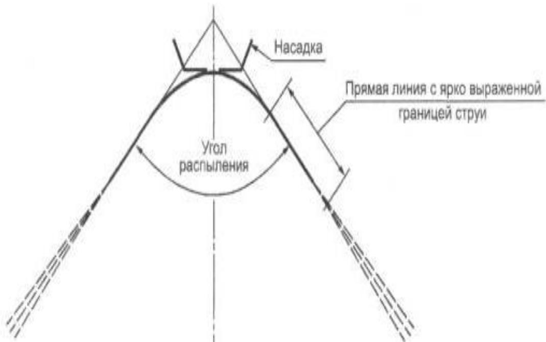
Рисунок 3.22. - Схема измерения угла распыления
