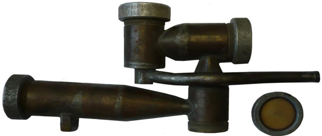
Рисунок 3.21 – Общий вид 4-х каскадного импактора МЭЯ
