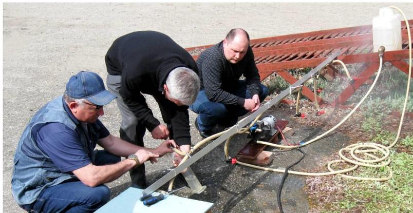
Рисунок 4.55 – Определение расхода рабочей жидкости объемным методом в гидравлической системе в зависимости от давления, создаваемого электронасосом ELP.TRIAL 9/12 116103973
