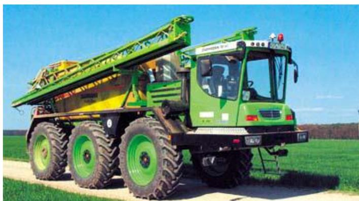
Рисунок 1.7 – Самоходный опрыскиватель фирмы DAMMANN (Германия) с вместимостью резервуаров до 10 тыс. литров и шириной захвата до 42 м
