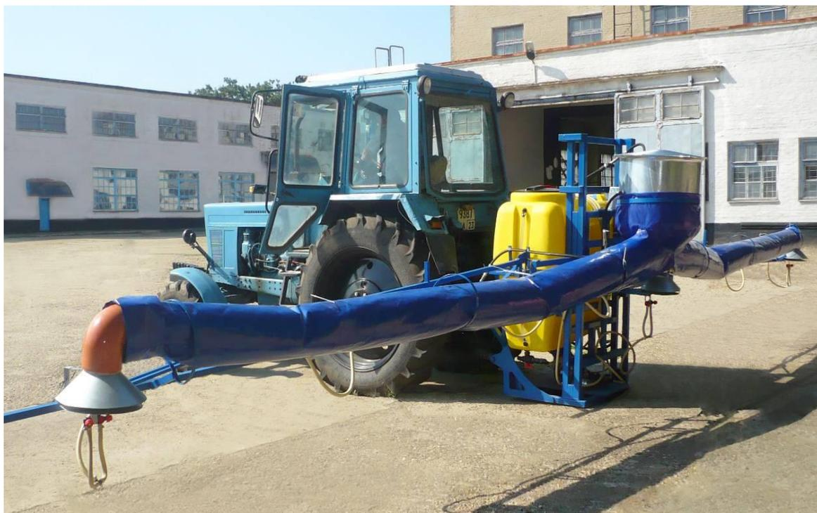
Рисунок 4.43 – Экспериментальный штанговый опрыскиватель в агрегате с МТЗ 80
