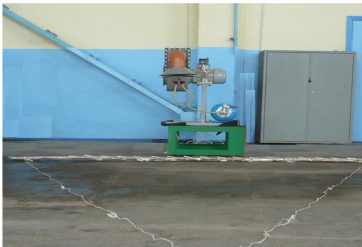
Рисунок 4.26 – Фрагмент проведения лабораторного опыта по улавливанию капель на учетные карточки
