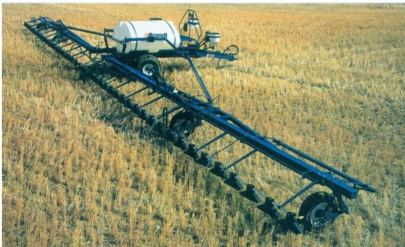
Рисунок 1.13 – Штанговый опрыскиватель с защитными экранами факелов распыляемой рабочей жидкости (BRANDT серии QF)
