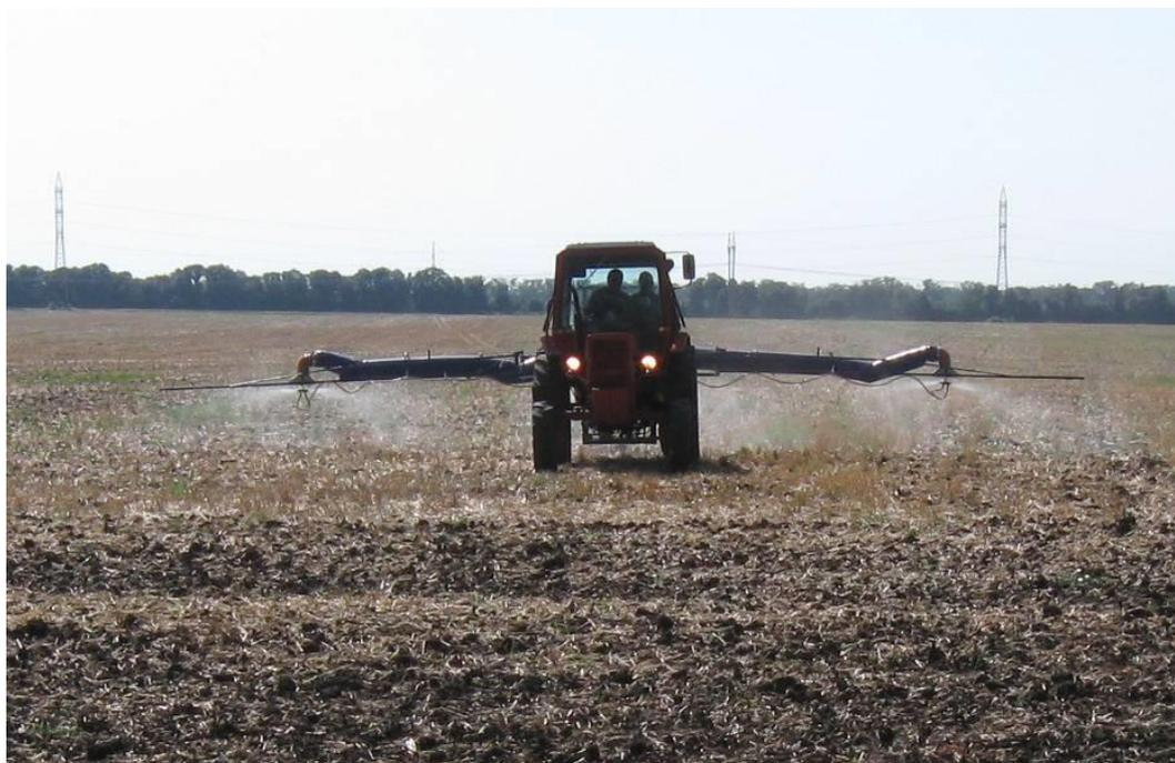
**Рисунок 4.46 – Общий вид экспериментального опрыскивателя в агрегате с МТЗ–82 при выполнении лабораторно – полевых опытов**
