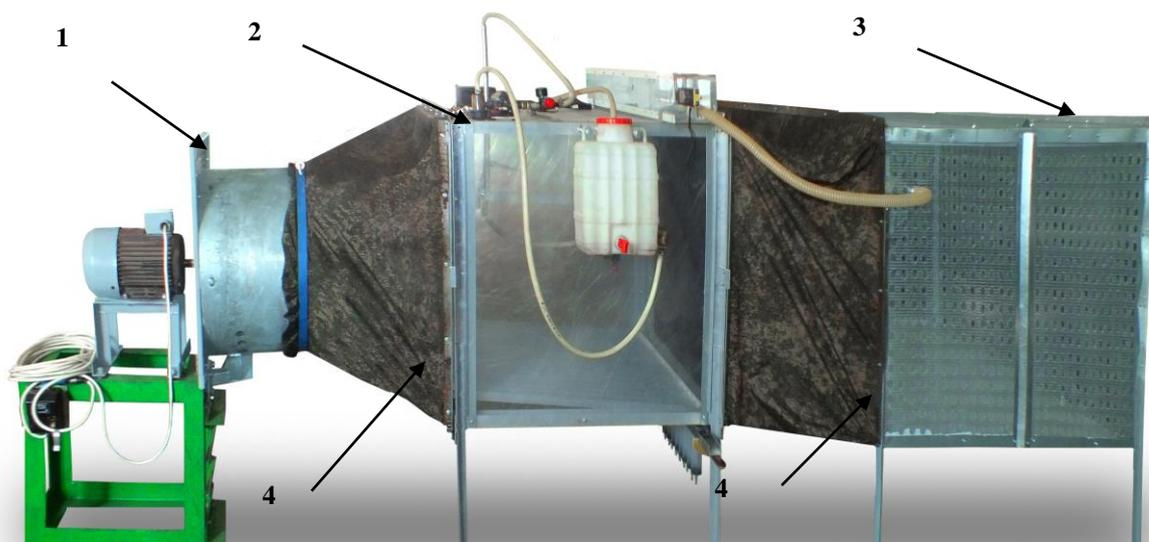
1 – модуль станда для моделирования скорости движения опрыскивателя воздушным потоком; 2 – модуль распыления водного раствора и улавливания диспергированной капельной жидкости в поперечном и продольном направлениях; 3 – камера уменьшения скорости воздушного потока и распределения мелкодисперсного аэрозоля (решетчатый корпус); 4 – кожух соединительный.
