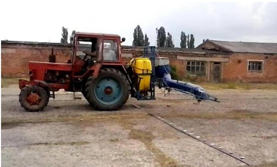
Рисунок 3.24 – Общий вид опрыскивателя, оснащенного пневмогидравлическими устройствами в составе МТЗ–82 при прохождении над объектами обработки (пронумерованными карточками)
