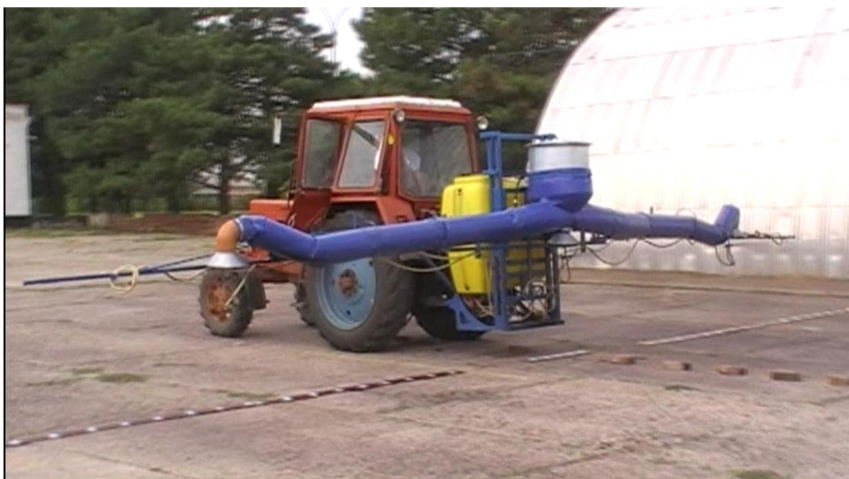
Рисунок 4.32 – Общий вид экспериментального опрыскивателя с пневмогидравлическими устройствами в составе МТЗ–82
