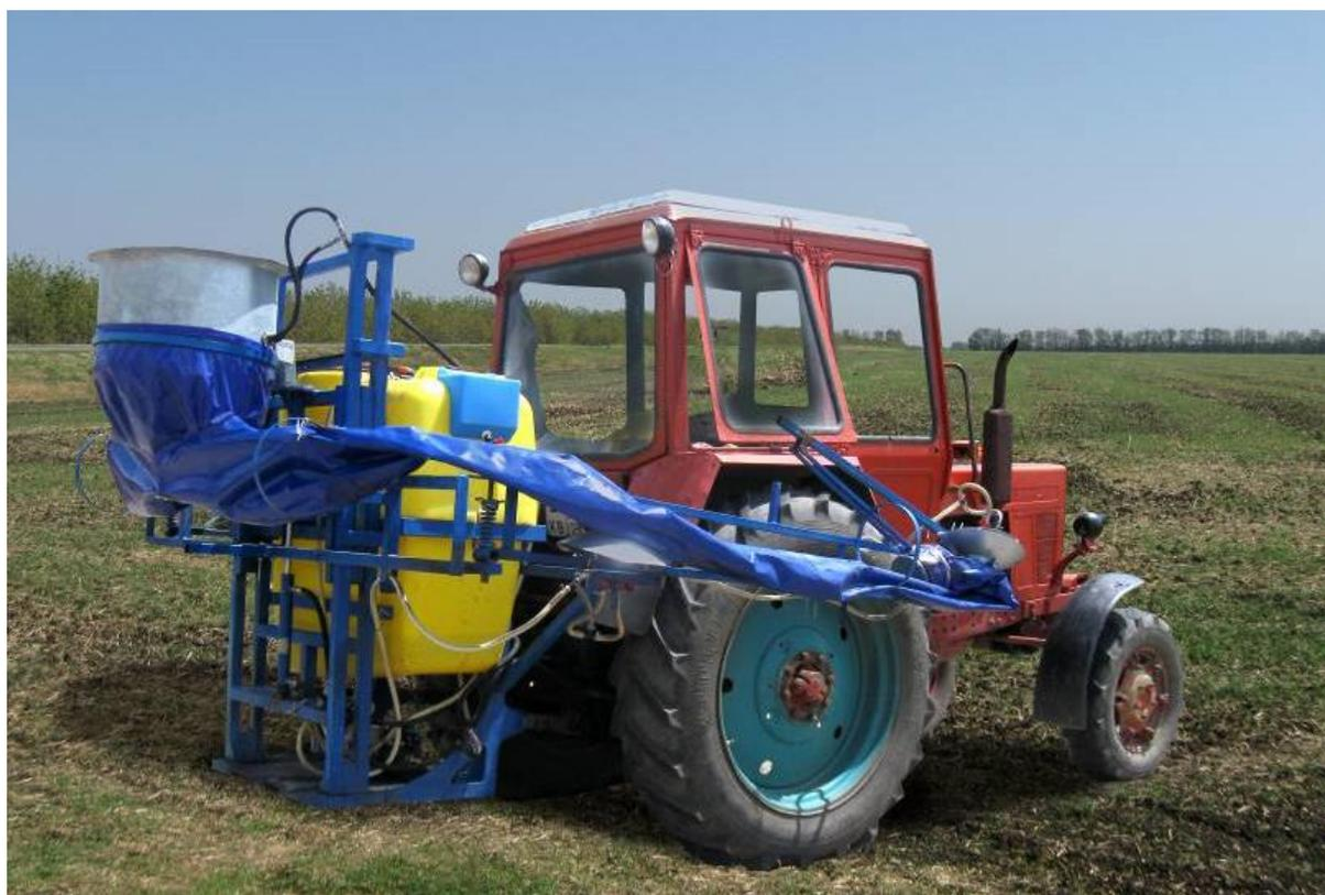
Рисунок 4.64 – Опрыскиватель РМ 229 с МТЗ–82 перед началом проведения лабораторно – полевых исследований (транспортное положение)
