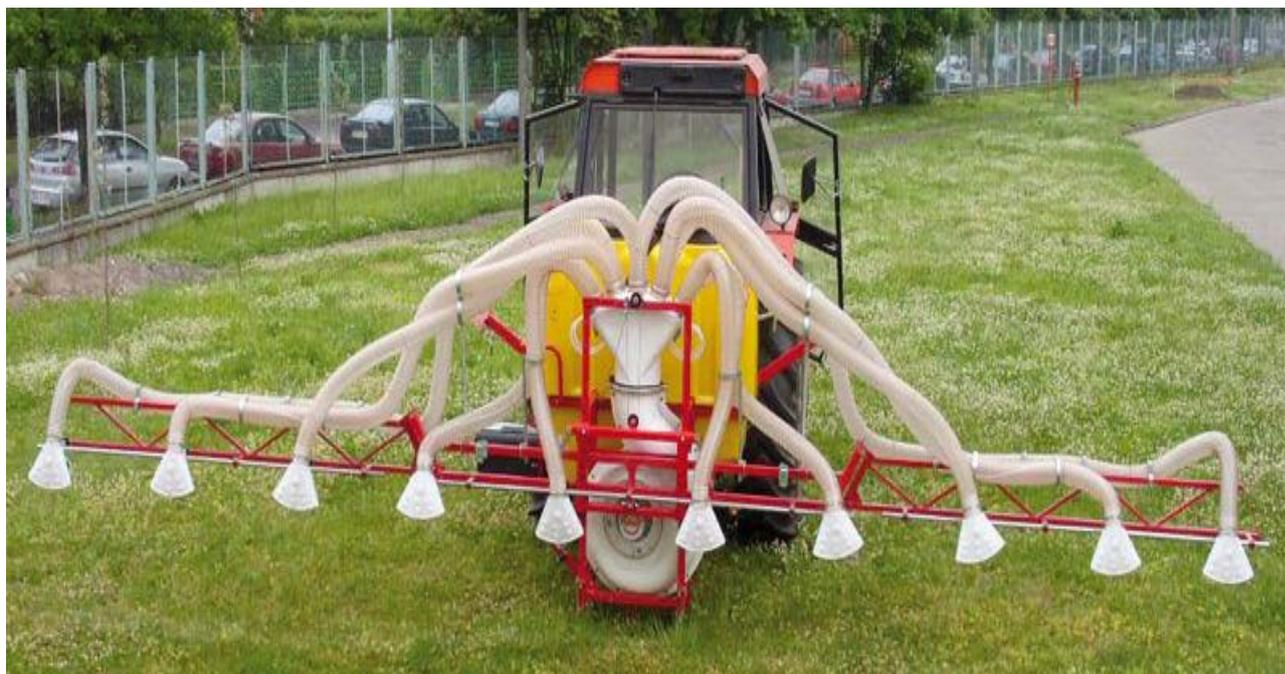
Рисунок 1.14 – Общий вид экспериментального образца навесного штангового опрыскивателя с защитными экранами и воздушным сопровождением капель факелов распыляемой рабочей жидкости к объектам обработки (разработка ООО «АгроТех»)
