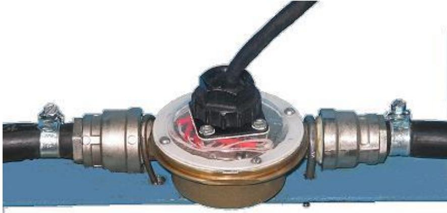
Рисунок 3.8 – Датчик расхода жидкости [75]
