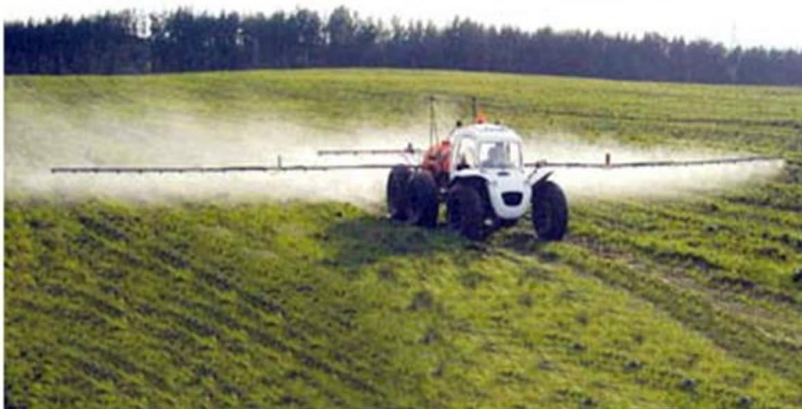
Рисунок 1.8 – Самоходный опрыскиватель ОПШ-05 на шинах-оболочках низкого давления
