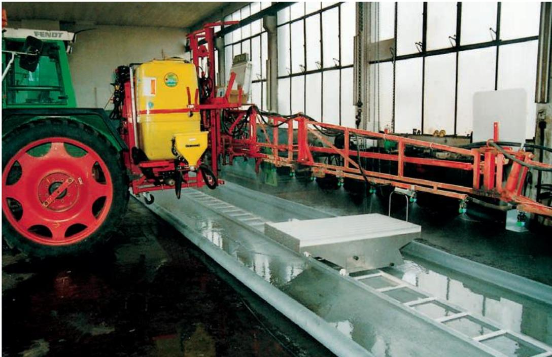
Рисунок 1.19 – Стенд для проверки работоспособности опрыскивающей техники в лабораторных условиях
