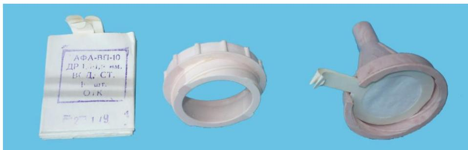
Рисунок 3.19 – Общий вид корпуса и фильтра АФА
