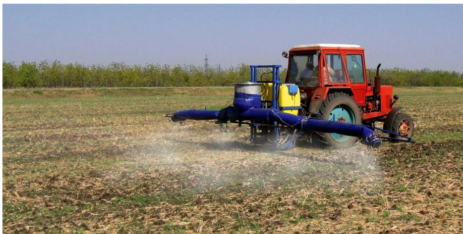
Рисунок 4.68 – Общий вид опытного образца опрыскивателя в составе с МТЗ–82 при проведении лабораторно – полевых исследований [77, 92]
