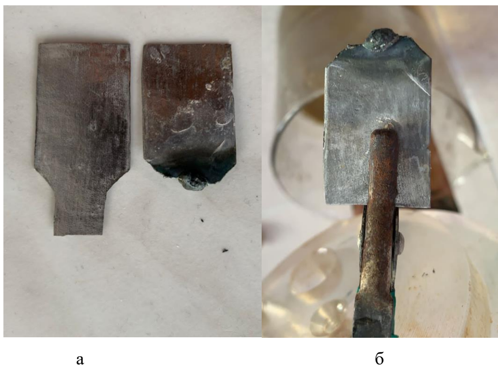
Рисунок 45 - Изображение образца: а - стандартный; б- после анодной обработки
