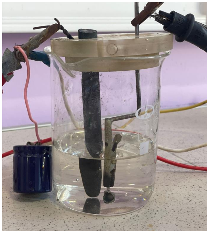
Рисунок 93 - Обработка металлического каркаса металлокерамической коронки плазменно-электролитной методикой
