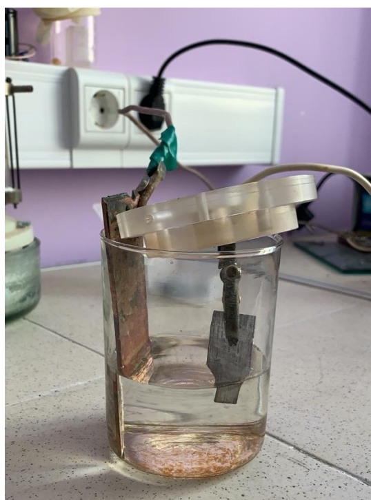
Рисунок 5 - Погружение образца в раствор электролита
