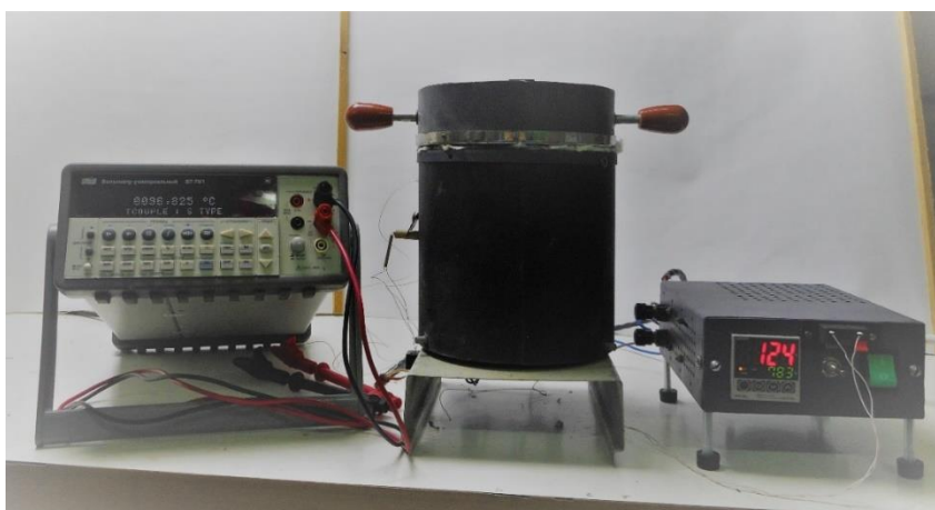
Рисунок 2.17. Общий вид установки для синтеза пленок \text{FeBO}_3
