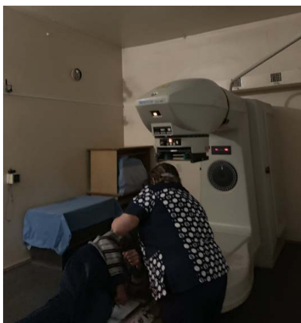
Рисунок 2.1 – Гамма-установка ИГУР-1 с источником \gamma -квантов ^{137}\text{Cs}
