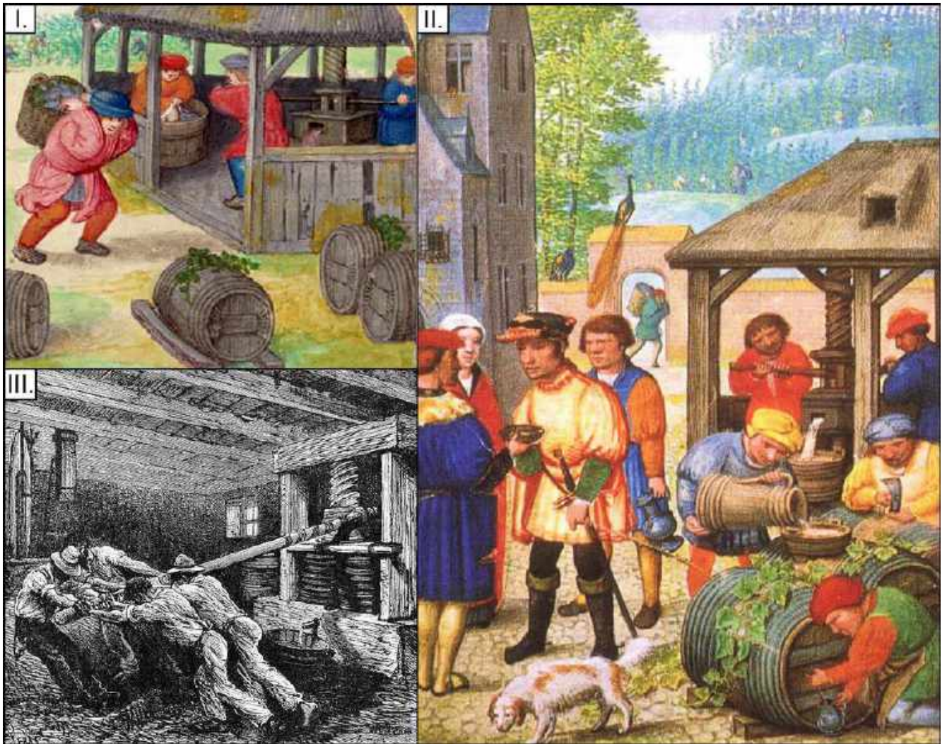
Рис. 195. Прессование винограда с помощью винтового пресса. I – доставка винограда, давка его ногами и работа винтового пресса на миниатюре из манускрипта « Horae cum calendario », 1510–1525 гг. (Национальная библиотека Франции, гр. 142); II – доставка винограда, работа винтового пресса на миниатюре из манускрипта « Golf Book » (Британская библиотека, add MS 24098); III – вертикальный винтовой пресс на гравюре второй половины XIX в. (Прованс, Франция), по: Lewit T. « terris, vineis, olivetis... »: Wine and Oil Production After the Villas // PCA. 2020. Vol. 10. P. 205, fig. 6.
