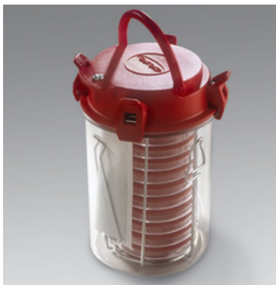
Рисунок 26 – Анаэростат фирмы Oxoid (Великобритания)
