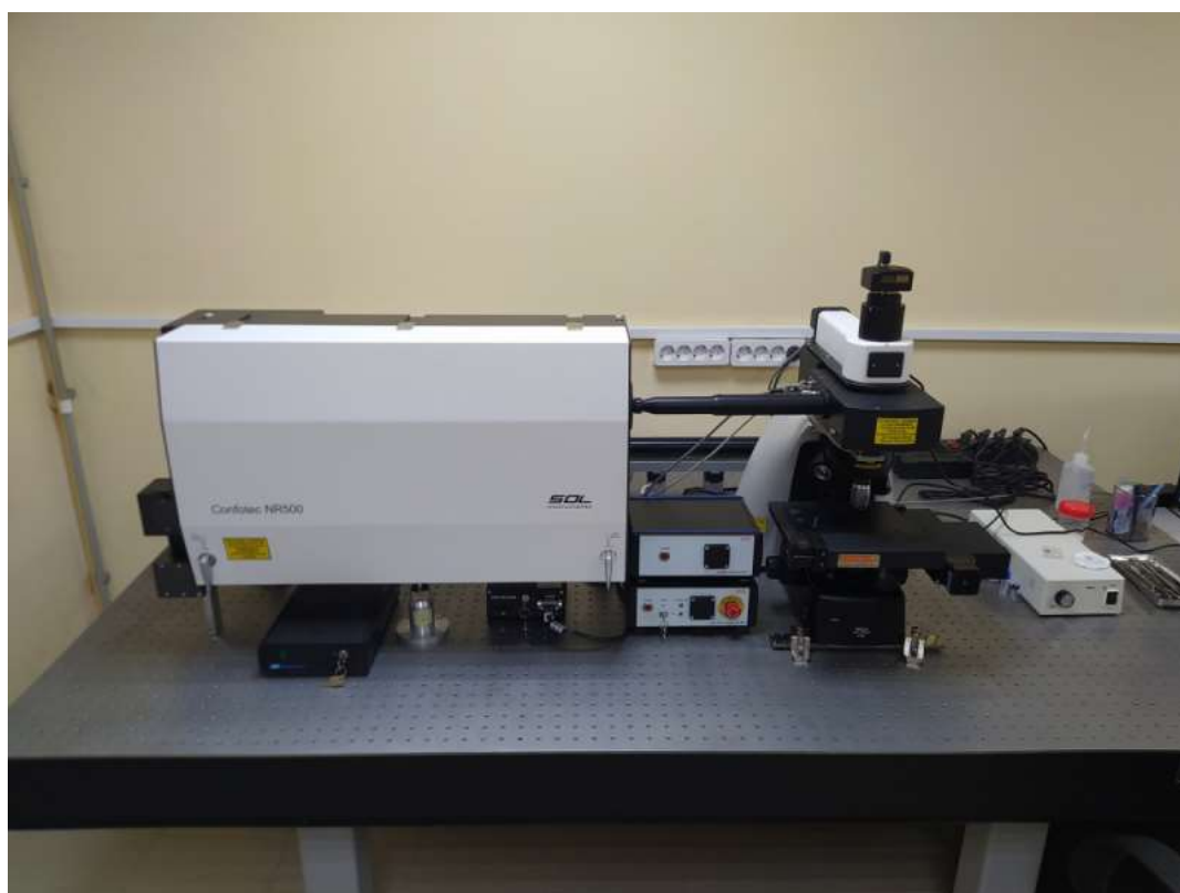
Рисунок 9 - Инвертированный микроскоп Eclipse Ti2 (Nikon Corporation, Япония) и рамановский конфокальный спектрометр Confotec NR500 (SOL Instruments, Беларусь)
