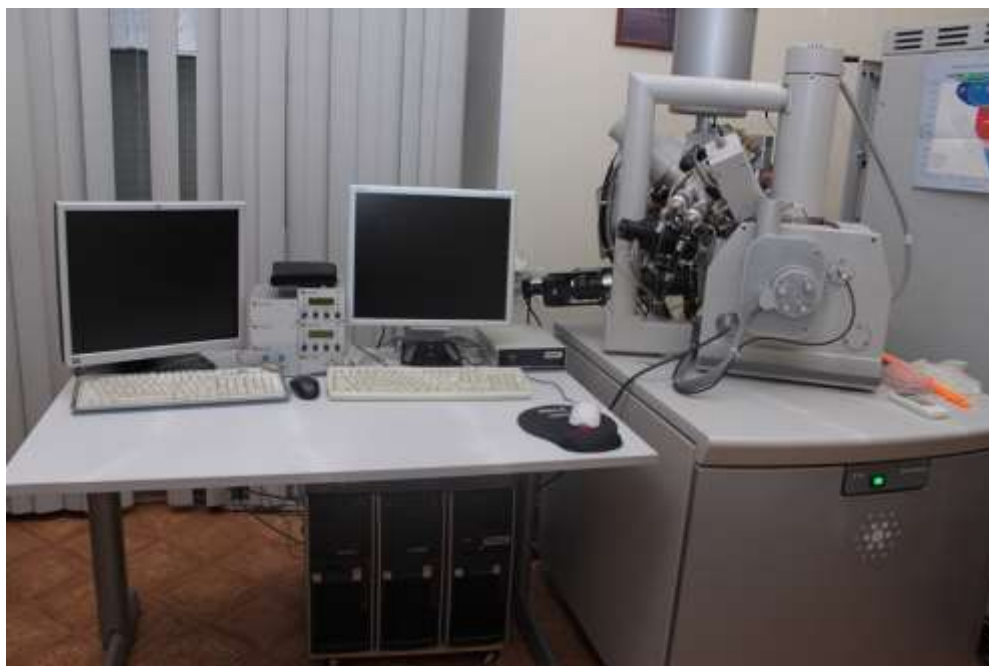
Рисунок 7 - Растровый электронный микроскоп Quanta 200i 3D FEI с энергодисперсионным кремневым детектора Apollo X
